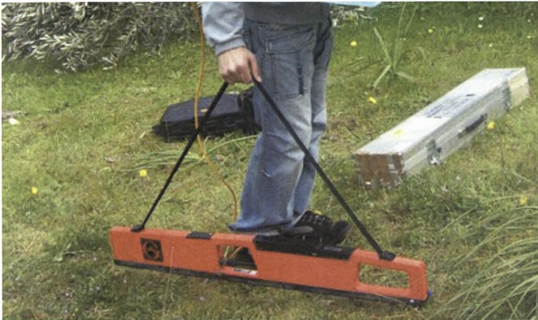
Σχήμα 21. Το μηχάνημα μέτρησης της φαινομενικής ηλεκτρικής αγωγιμότητας (ECa), EM 38
