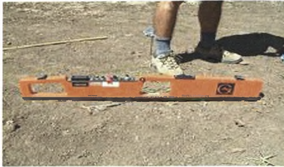
Σχήμα 10. Αισθητήρας ηλεκτρομαγνητικής επαγωγής (EM 38 ) του οίκου Geonics Limited
