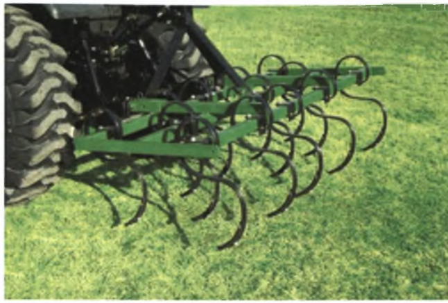
Σχήμα 12. Οδοντωτή σβάρνα με ελατηριωτά δόντια τύπου S
