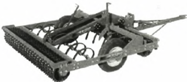
Σχήμα 24. Συνδυασμός εργαλείων σε μηχανήματα δευτερογενούς κατεργασίας
