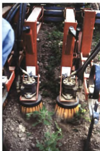
Σχήμα 30. Βούρτσα με κάθετο άξονα
