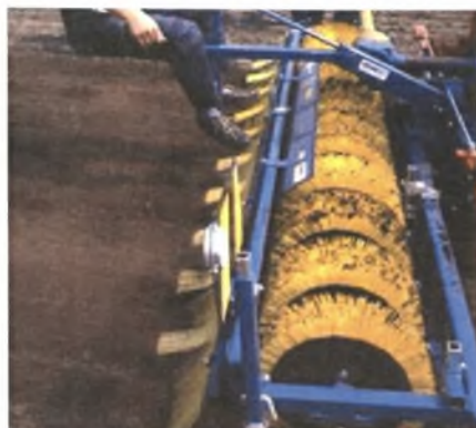
Σχήμα 29. Βούρτσα με οριζόντιο άξονα
