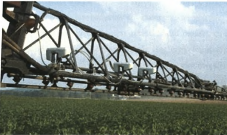
Σχήμα 37. Αισθητήρες προσαρμοσμένοι στο σύστημα ψεκασμού για το βαμβάκι
