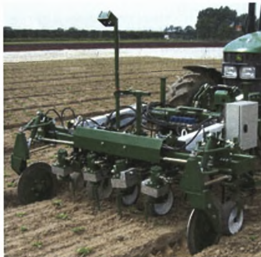
Σχήμα 21. Περιστροφικό σκαλιστήρι με δίσκο
