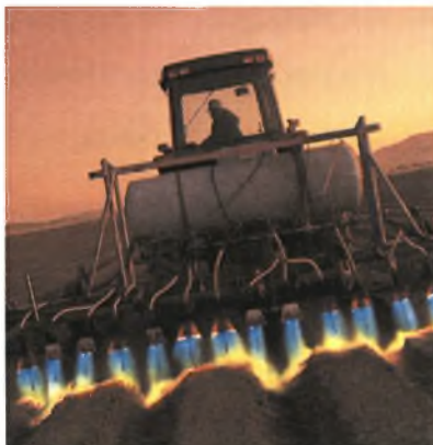
Σχήμα 27. Φλογοβόλα καταστροφής ζιζανίων με χρήση προπανίου
