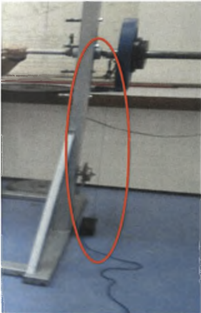
Εικόνα 3.3: Προσαρμογή του κωδικοποιητή στη μπάρα.
