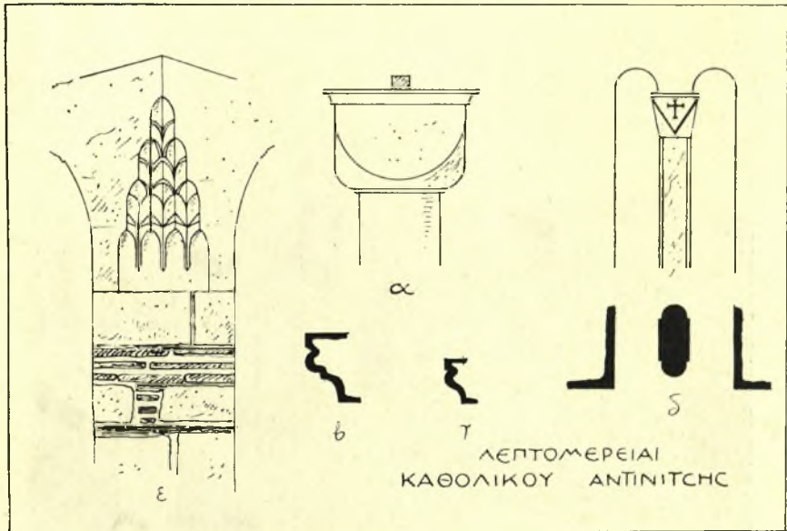
Εἰκ. 4. Λεπτομέρειαι τοῦ καθολικοῦ τῆς Ἀντινίτσης: α κιονόκρανον, β, γ τομαὶ κοσμητῶν, δ παράθυρον ἱεροῦ, ε σταλακτιτοειδῆς διαμόρφωσις τῆς γωνίας τῶν παρεκκλησίων.
