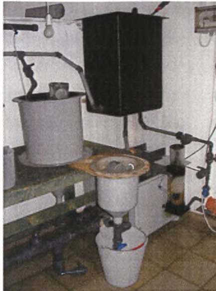
Εικόνα 9: Η δεξαμενή συλλογής ναυπλίων στο κλειστό κύκλωμα καλλιέργειας Κωπηπόδων.
