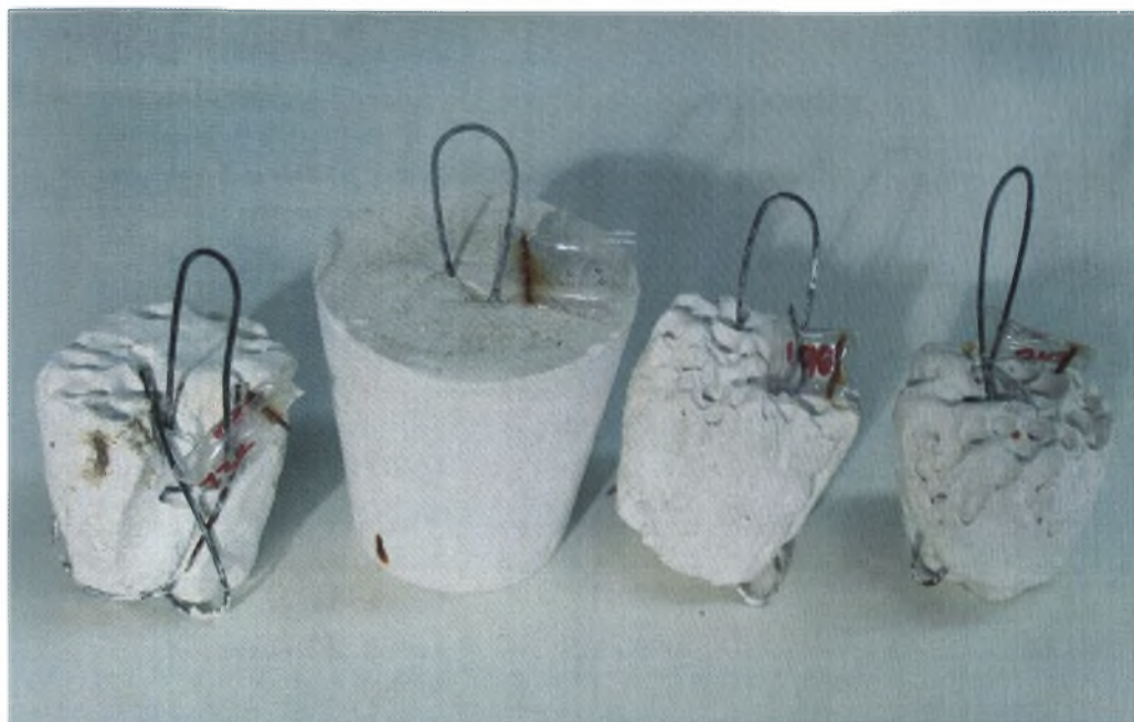
Εικ. 23. Γύψινοι όγκοι, πριν και μετά την παραμονή τους στη θάλασσα για 24 ώρες, όπου φαίνεται η διάβρωση που υπέστησαν.
