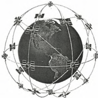
Εικόνα 2.1 Σχηματική απεικόνιση των 24 δορυφόρων που αποτελούν το παγκόσμιο σύστημα καθορισμού θέσης (GPS).
