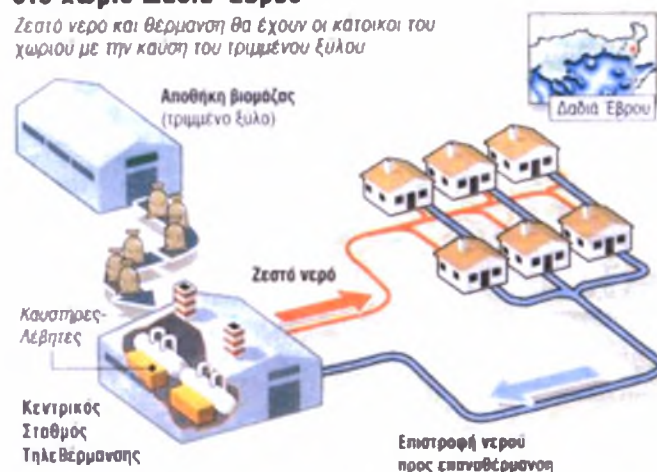
Εικόνα 23:Σύστημα τηλεθέρμανσης στον Έβρο
