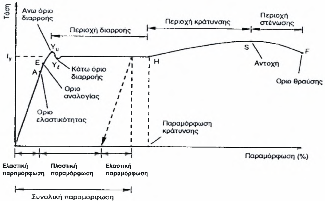
Γράφημα 11. Διάγραμμα τάσης παραμόρφωσης ενός τυπικού υλικού (Πηγή: Λίτινας και Γιαννακόπουλος, 1999).
