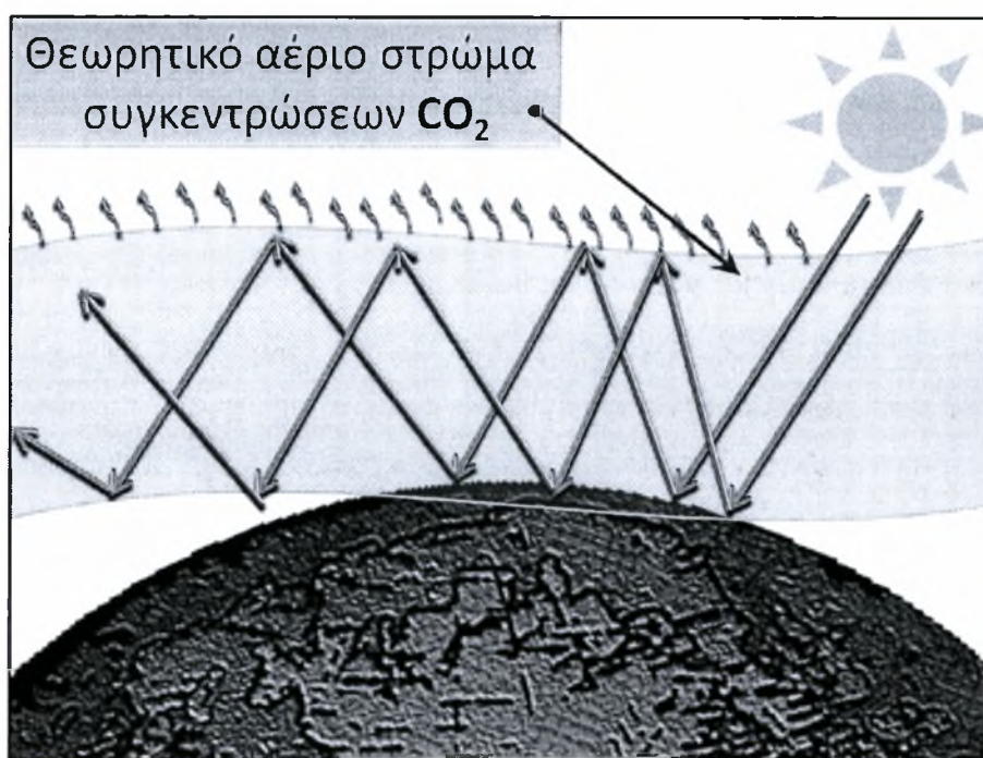
Σχήμα 14. Σχηματική απόδοση του φαινομένου του θερμοκηπίου (σχεδίαση: Δημήτρης Τσιώτας).
