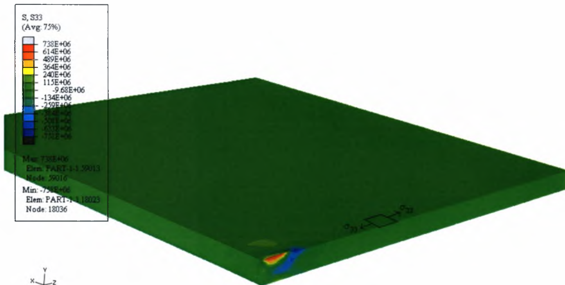
Σχήμα 5.17: Ισοψείς τάσεως \sigma_{33} για t=0.2\text{sec} (DELTMX=3000)
