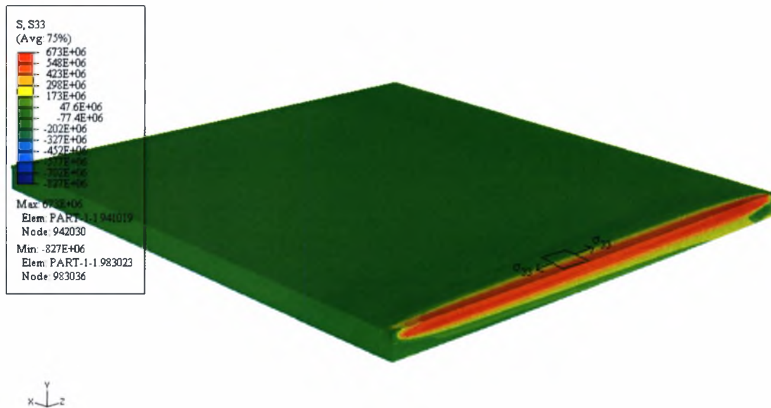
Σχήμα 5.20: Ισοϋψείς τάσεως \sigma_{33} για t=10\text{sec} (DELTMX=3000)
