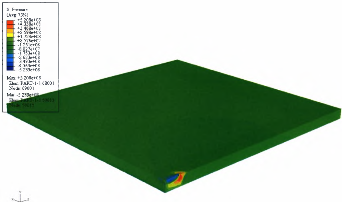
Σχήμα 5.7: Ισοϋψείς της πίεσης για t=0.2\text{sec} (DELTMX=3000)
