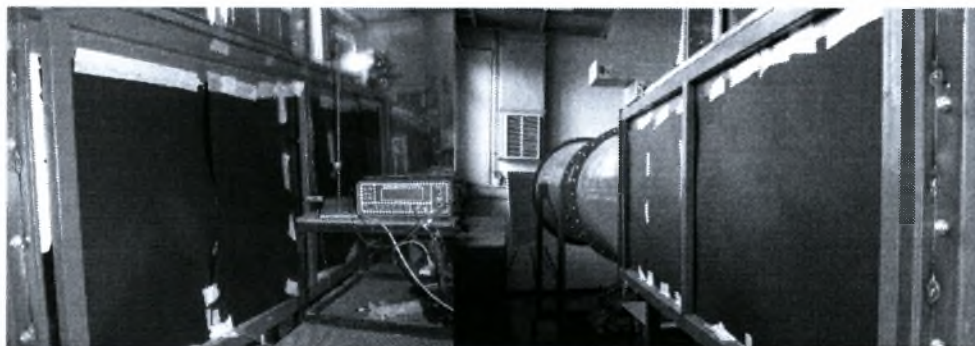
Εικόνα 3. 14. Κάλυψη αεροσήραγγας με χαρτόνια
