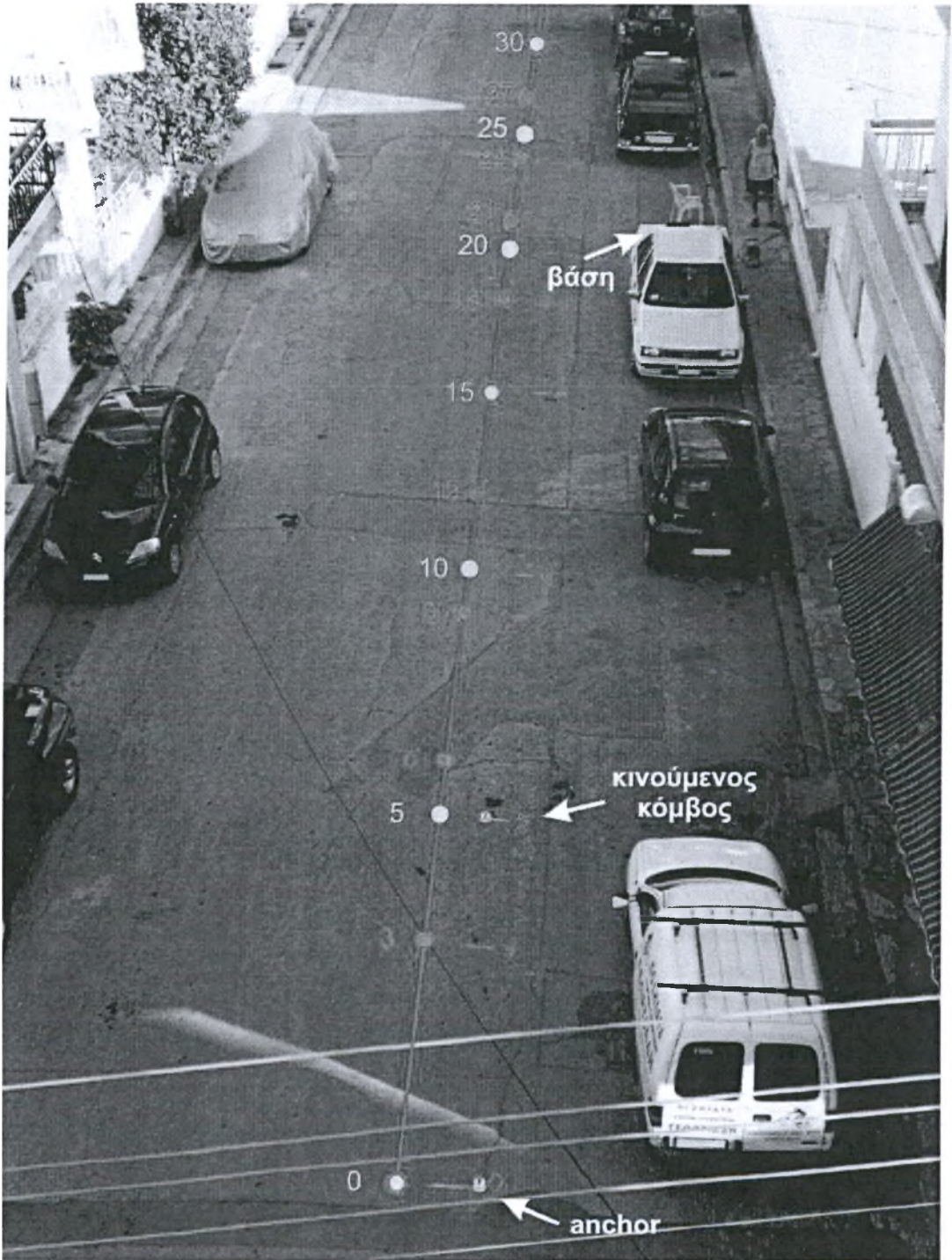
Εικόνα 4.4: Ο δρόμος, όπως βαθμονομήθηκε για τις ανάγκες του πειράματος και οι θέσεις των αισθητήρων (με μπλε η βαθμονόμηση των 30m και με κίτρινο των 50m)
