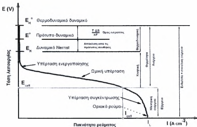
Σχήμα 2.2: Γραφική απεικόνιση της χαρακτηριστικής καμπύλης λειτουργίας μιας κυψέλης καυσίμου.
