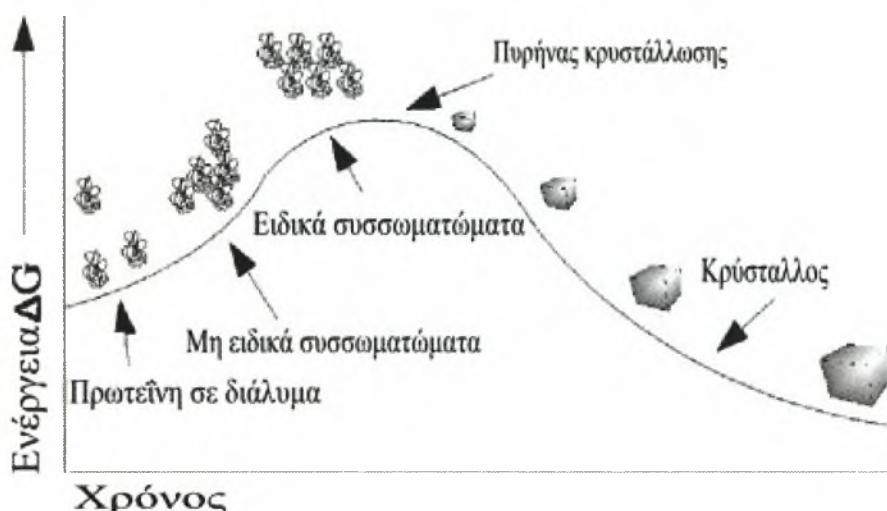
ΕΙΚΟΝΑ 6.4: Διάγραμμα ελεύθερης ενέργειας ( \Delta G ) σε σχέση με το χρόνο ( t ). Η πρωτεΐνη θα υπερβεί ένα φράγμα ενέργειας προκειμένου να μπορέσει να κρυσταλλώσει
