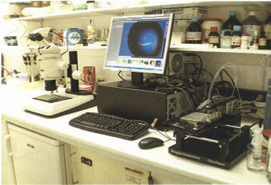
ΕΙΚΟΝΑ 6.5: Στερεοσκόπιο και ρομποτικό σύστημα κρυστάλλωσης πρωτεϊνών στο εργαστήριο Δομικής Βιολογία και Χημείας, ΕΙΕ
