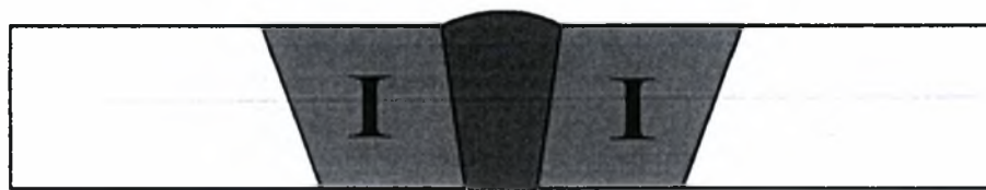
Εικόνα 2.3 – Σχηματική Απεικόνιση ΘΕΖ Συγκόλλησης Αλουμινίου
