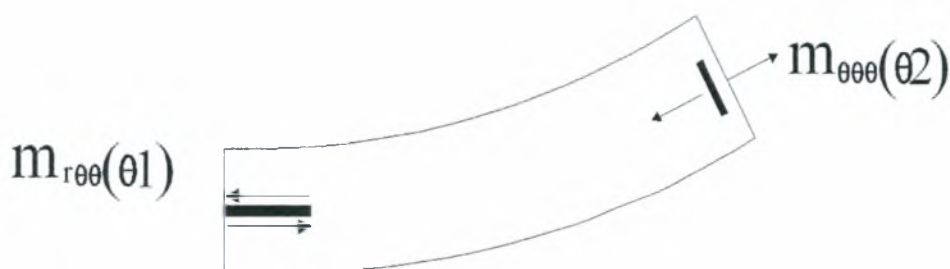
Σχήμα 3.2.7: Επιβαλλόμενα διπολικά φορτία τύπου m_{r\theta\theta} και m_{\theta\theta\theta} στο αριστερό και δεξιό σύνορο.
