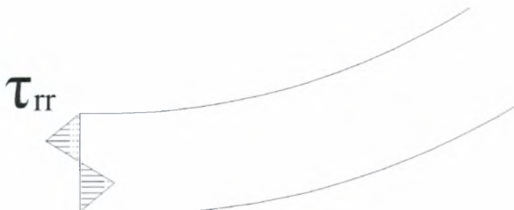
Σχήμα 3.2.4: Κατανομή τάσης \tau_{rr} μήκος μιας διατομής.
