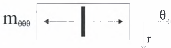
Σχήμα 2.3: Σχηματική παρουσίαση της διπολικής τάσης m_{\theta\theta\theta} .
