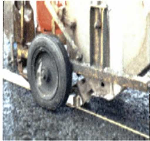
Εικόνα 1.28: Λεπτομέρεια του μηχανισμού. Στο πίσω μέρος διακρίνεται η θήκη με τα γυάλινα σφαιρίδια, τα οποία στη συγκεκριμένη περίπτωση διασπείρονται μετά την έγχυση του υλικού στο οδόστρωμα.
