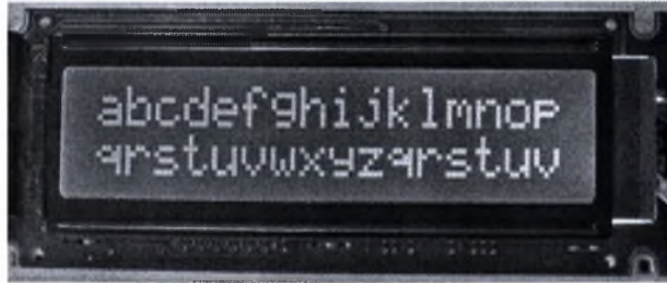
Εικόνα 5.1: LCD οθόνη 16x2 χαρακτήρων με ελεγκτή HD44780
