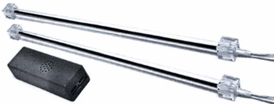
Εικόνα 6.1: CCFL λάμπες υπεριώδους ακτινοβολίας και κύκλωμα οδήγησης (πολλαπλασιαστής)
