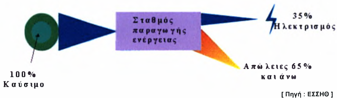
(α) Τυπικό συμβατικό σύστημα παραγωγής ηλεκτρικής ενέργειας
