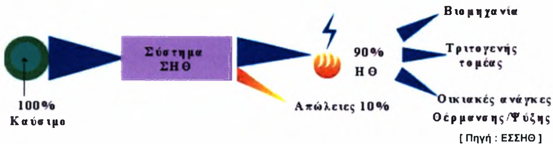
(β) Σύστημα συμπαραγωγής ηλεκτρισμού και θερμότητας
