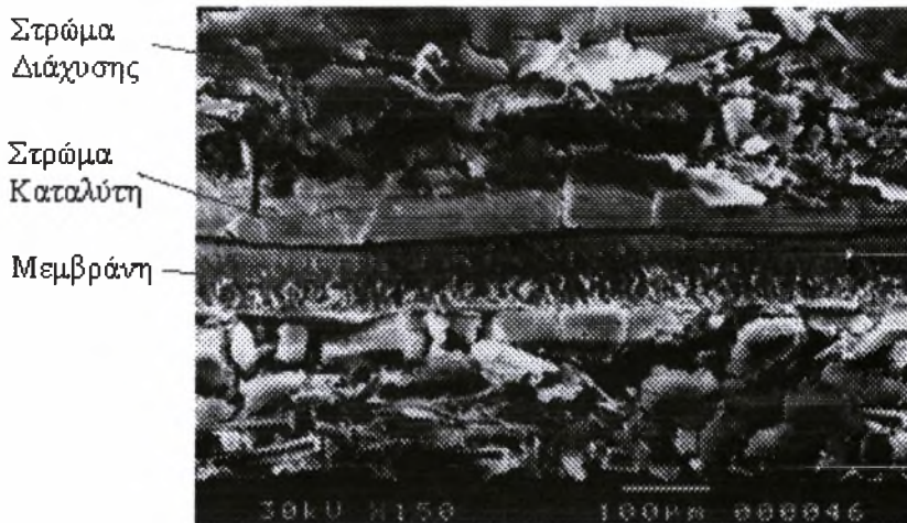
Σχήμα 5.22: Παρατήρηση της διάταξης ηλεκτροδίου/μεμβράνης σε οπτικό μικροσκόπιο
