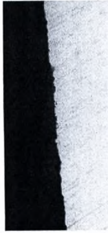
Εικόνα 6-4β: Μεταλλογραφία δοκιμίου NC7 πειράματος φυσικής διάβρωσης. Μεγέθυνση \times 50 . Χρόνος έκθεσης 21 μήνες.
