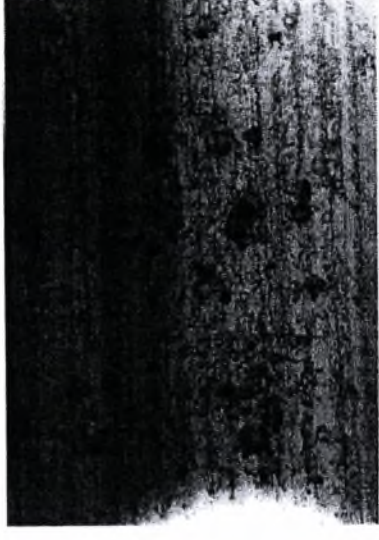
Εικόνα 6-3στ: Στερεοσκοπία δοκιμίου NC7 πειράματος φυσικής διάβρωσης. Μεγέθυνση \times 50 . Χρόνος έκθεσης 21 μήνες.
