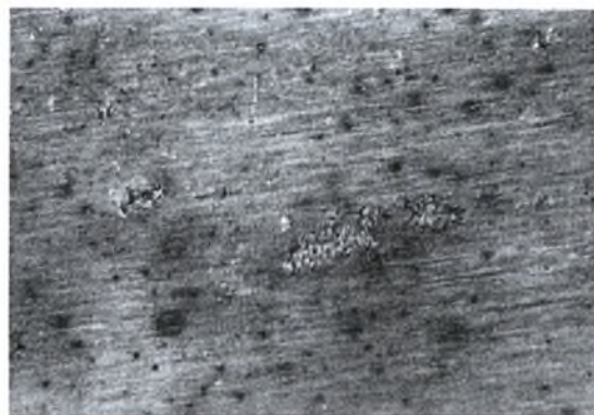
Εικόνα Η-16: Στερεοσκοπία δοκιμίου Μ4 πειράματος Modified EXCO Test. Μεγέθυνση \times 16 . Χρόνος έκθεσης 12 ώρες.
