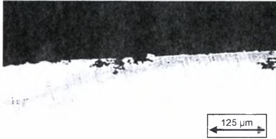
Εικόνα Θ-111: Μεταλλογραφία δοκιμίου Δ4 πειράματος Alternate Immersion Test AI 2024-T3. Μεγέθυνση \times 10 . Χρόνος έκθεσης 15 ημέρες.
