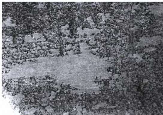
Εικόνα Η-85: Στερεοσκοπία δοκιμίου M10 πειράματος Modified EXCO Test. Μεγέθυνση \times 16 . Χρόνος έκθεσης 96 ώρες.
