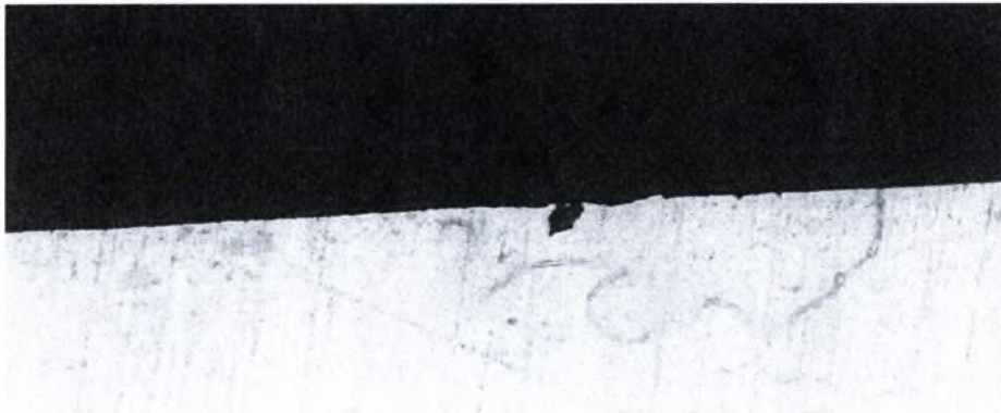
Εικόνα ΣΤ-82: Μεταλλογραφία δοκιμίου NC4 πειράματος φυσικής διαβρωσης Al 2024-T3. Μεγέθυνση \times 50 . Χρόνος έκθεσης 12 μήνες.
