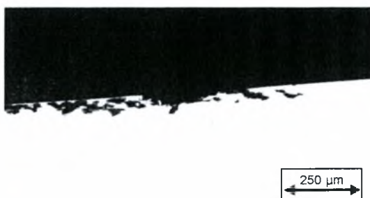
Εικόνα 5-27δ: Μεταλλογραφία δοκιμίου M3 πειράματος Modified EXCO Test. Μεγέθυνση \times 10 . Χρόνος έκθεσης 8 ώρες.
