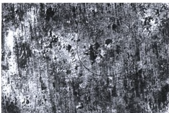
Εικόνα Θ-21: Στερεοσκοπία δοκιμίου Δ3 πειράματος Alternate Immersion Test AI 2024-T3. Μεγέθυνση \times 25 . Χρόνος έκθεσης 10 ημέρες.
