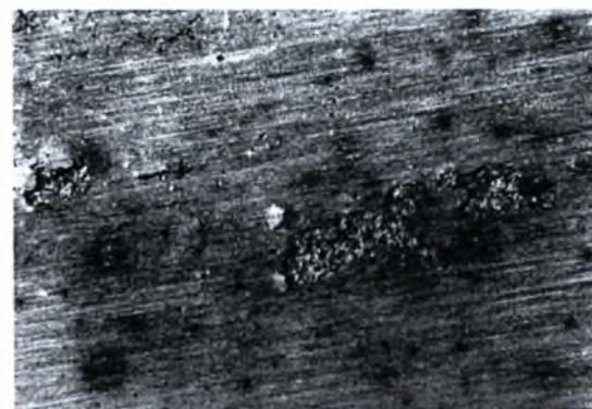
Εικόνα 5-26στ: Στερεοσκοπία δοκιμίου M4 πειράματος Modified EXCO Test. Μεγέθυνση \times 25 . Χρόνος έκθεσης 12 ώρες. Διάβρωση αποφλοιώσης (exfoliation).
