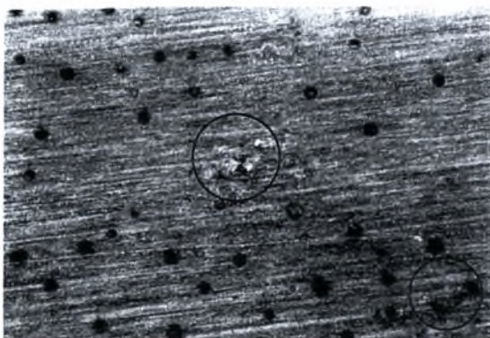
Εικόνα 5-26γ: Στερεοσκοπία δοκιμίου M2 πειράματος Modified EXCO Test. Μεγέθυνση \times 25 . Χρόνος έκθεσης 5 ώρες. Σημειακή διάβρωση και αρχή exfoliation.
