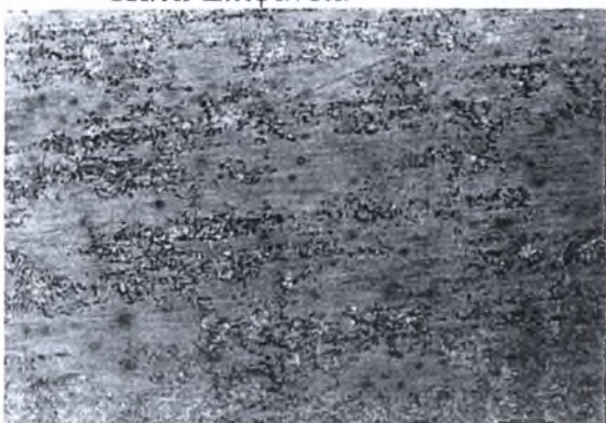
Εικόνα Η-70: Στερεοσκοπία δοκιμίου Μ9 πειράματος Modified EXCO Test. Μεγέθυνση \times 10 . Χρόνος έκθεσης 72 ώρες.
