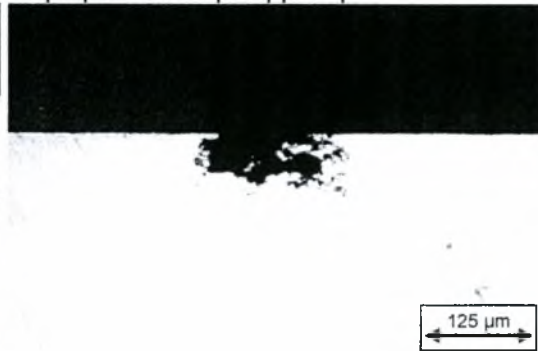
Εικόνα 5-34ι: Μεταλλογραφία δοκιμίου Δ6 πειράματος Alternate Immersion. Μεγέθυνση \times 20 . Χρόνος έκθεσης 45 ημέρες. Περικρυσταλλική διάβρωση.
