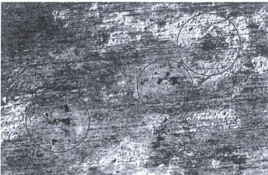
Εικόνα Θ-13: Στερεοσκοπία δοκιμίου Δ2 πειράματος Alternate Immersion Test AI 2024-T3. Μεγέθυνση \times 40 . Χρόνος έκθεσης 5 ημέρες.
