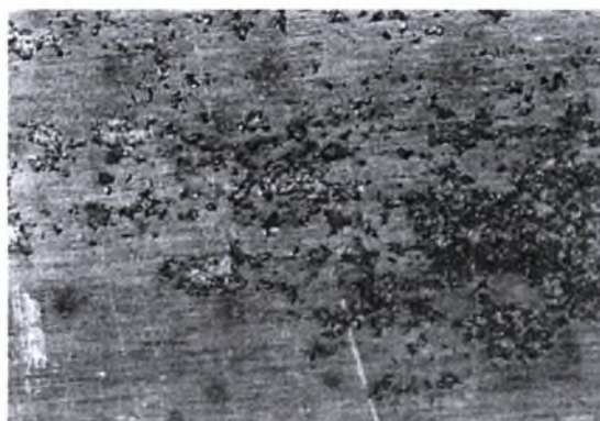
Εικόνα Η-76: Στερεοσκοπία δοκιμίου Μ9 πειράματος Modified EXCO Test. Μεγέθυνση \times 25 . Χρόνος έκθεσης 72 ώρες.
