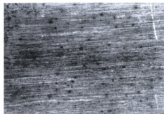
Εικόνα Η-59: Στερεοσκοπία δοκιμίου Μ8 πειράματος Modified EXCO Test. Μεγέθυνση \times 16 . Χρόνος έκθεσης 48 ώρες. Καθαρότερη από την άνω επιφάνεια.
