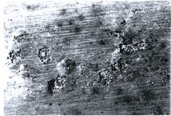
Εικόνα Η-20: Στερεοσκοπία δοκιμίου M4 πειράματος Modified EXCO Test. Μεγέθυνση \times 25 . Χρόνος έκθεσης 12 ώρες.
