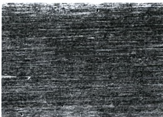
Εικόνα Z-13: Στερεοσκοπία δοκιμίου A8 πειράματος EXCO Test AI 2024-T3. Μεγέθυνση \times 16 . Χρόνος έκθεσης 8 ώρες.
