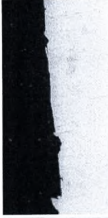
Εικόνα 6-4γ: Μεταλλογραφία δοκιμίου NC8 πειράματος φυσικής διάβρωσης. Μεγέθυνση \times 50 . Χρόνος έκθεσης 24 μήνες.
