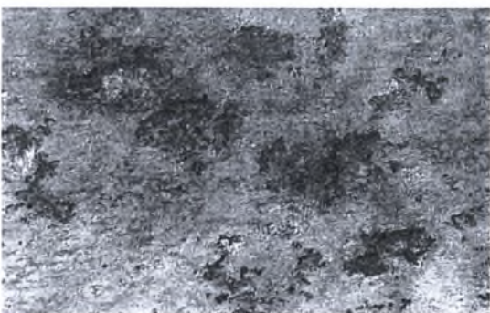
Εικόνα Θ-86: Στερεοσκοπία δοκιμίου Δ8 πειράματος Alternate Immersion Test AI 2024-T3. Μεγέθυνση \times 10 . Χρόνος έκθεσης 75 ημέρες.
