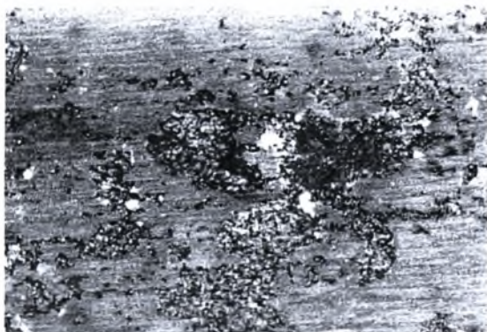
Εικόνα Η-56: Στερεοσκοπία δοκιμίου Μ8 πειράματος Modified EXCO Test. Μεγέθυνση \times 25 . Χρόνος έκθεσης 48 ώρες.
