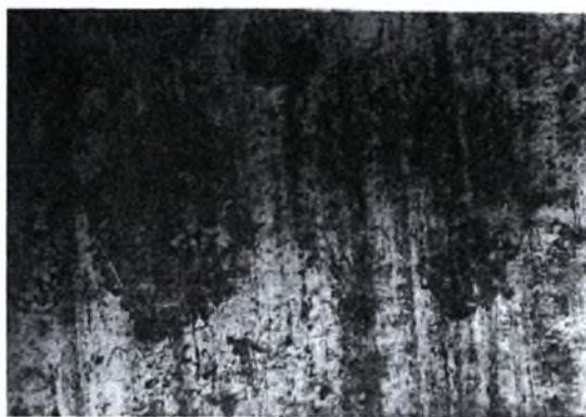
Εικόνα ΣΤ-63: Στερεοσκοπία δοκιμίου NC8 πειράματος φυσικής διάβρωσης ΑΙ 2024-Τ3. Μεγέθυνση \times 50 . Χρόνος έκθεσης 24 μήνες.
