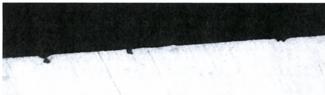
Εικόνα ΣΤ-87: Μεταλλογραφία δοκιμίου NC5 πειράματος φυσικής διάβρωσης Al 2024-T3. Μεγέθυνση \times 50 . Χρόνος έκθεσης 15 μήνες.
