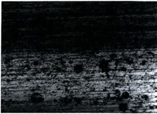
Εικόνα 5-7ιγ: Στερεοσκοπία δοκιμίου NC7 πειράματος φυσικής διάβρωσης Al 2024-T3. Μεγέθυνση \times 20 . Χρόνος έκθεσης 21 μήνες.
