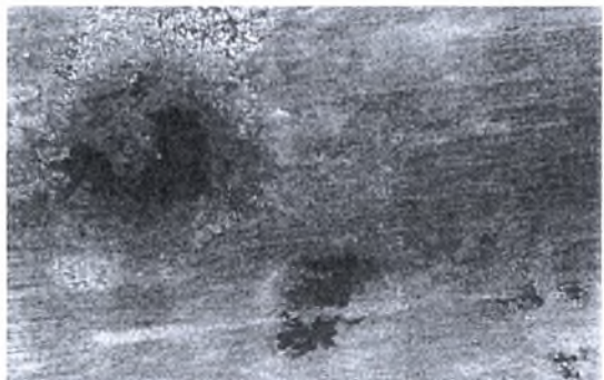
Εικόνα Θ-83: Στερεοσκοπία δοκιμίου Δ8 πειράματος Alternate Immersion Test AI 2024-T3. Μεγέθυνση \times 25 . Χρόνος έκθεσης 75 ημέρες.
