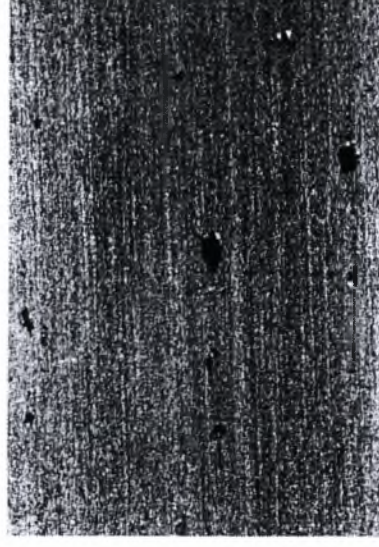
Εικόνα 6-31ζ: Στερεοσκοπία δοκιμίου A12 πειράματος EXCO Test. Μεγέθυνση \times 25 . Χρόνος έκθεσης 12 ώρες.
