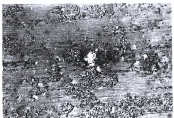
Εικόνα H-55: Στερεοσκοπία δοκιμίου M8 πειράματος Modified EXCO Test. Μεγέθυνση \times 16 . Χρόνος έκθεσης 48 ώρες. Exfoliation και Pitting.
