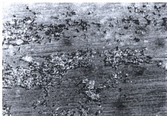
Εικόνα Η-73: Στερεοσκοπία δοκιμίου Μ9 πειράματος Modified EXCO Test. Μεγέθυνση \times 40 . Χρόνος έκθεσης 72 ώρες.
