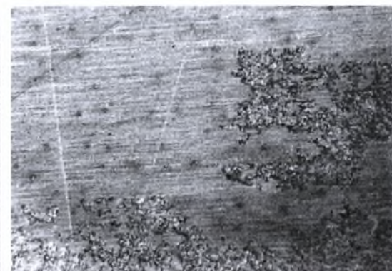
Εικόνα H-67: Στερεοσκοπία δοκιμίου M9 πειράματος Modified EXCO Test. Μεγέθυνση \times 16 . Χρόνος έκθεσης 72 ώρες.
