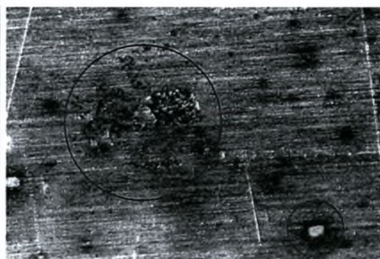
Εικόνα 5-26ι: Στερεοσκοπία δοκιμίου M6 πειράματος Modified EXCO Test. Μεγέθυνση \times 25 . Χρόνος έκθεσης 24 ώρες. Διάβρωση αποφλοιώσης (exfoliation) και γέννηση pit.
