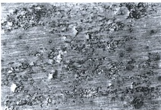
Εικόνα Η-48: Στερεοσκοπία δοκιμίου Μ7 πειράματος Modified EXCO Test. Μεγέθυνση \times 16 . Χρόνος έκθεσης 36 ώρες.
