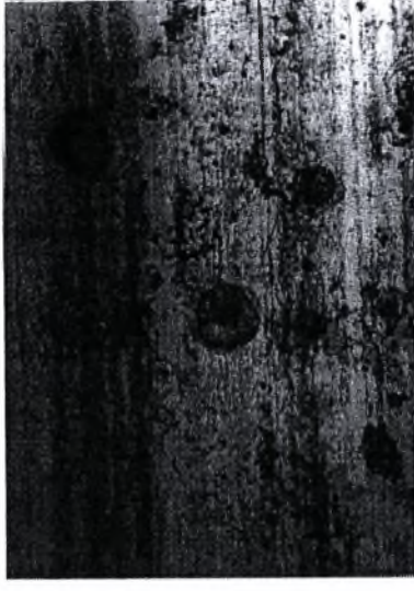
Εικόνα 6-3γ: Στερεοσκοπία δοκιμίου NC6 πειράματος φυσικής διάβρωσης. Μεγέθυνση \times 50 . Χρόνος έκθεσης 18 μήνες.
