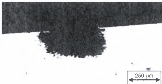
Εικόνα Θ-115: Μεταλλογραφία δοκιμίου Δ5 πειράματος Alternate Immersion Test AI 2024-T3. Μεγέθυνση \times 10 . Χρόνος έκθεσης 30 ημέρες.
