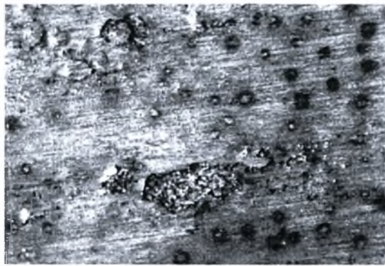
Εικόνα 5-26η: Στερεοσκοπία δοκιμίου M5 πειράματος Modified EXCO Test. Μεγέθυνση \times 25 . Χρόνος έκθεσης 16 ώρες. Διάβρωση αποφλοιώσης (exfoliation).
