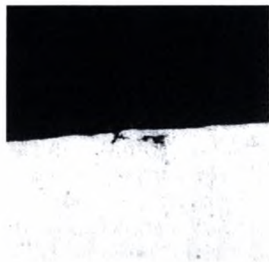
Εικόνα 5-7δ: Μεταλλογραφία δοκιμίου NC2 πειράματος φυσικής διάβρωσης Al 2024-T3. Μεγέθυνση \times 50 . Χρόνος έκθεσης 6 μήνες
