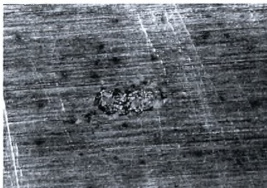
Εικόνα 5-26ιζ: Στερεοσκοπία δοκιμίου M9 πειράματος Modified EXCO Test. Μεγέθυνση \times 25 . Χρόνος έκθεσης 72 ώρες.
