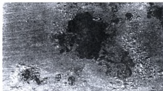
Εικόνα Θ-80: Στερεοσκοπία δοκιμίου Δ8 πειράματος Alternate Immersion Test AI 2024-T3. Μεγέθυνση \times 25 . Χρόνος έκθεσης 75 ημέρες.
