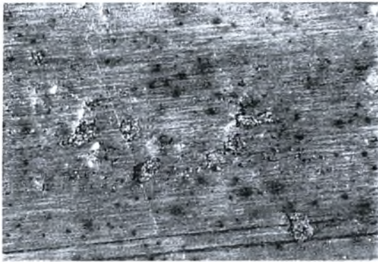
Εικόνα Η-19: Στερεοσκοπία δοκιμίου M4 πειράματος Modified EXCO Test. Μεγέθυνση \times 16 . Χρόνος έκθεσης 12 ώρες.
