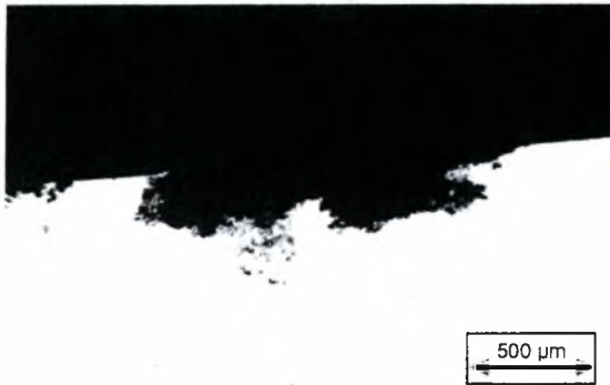
Εικόνα 5-34γ: Μεταλλογραφία δοκιμίου Δ8 πειράματος Alternate Immersion. Μεγέθυνση \times 5 . Χρόνος έκθεσης 75 ημέρες.
