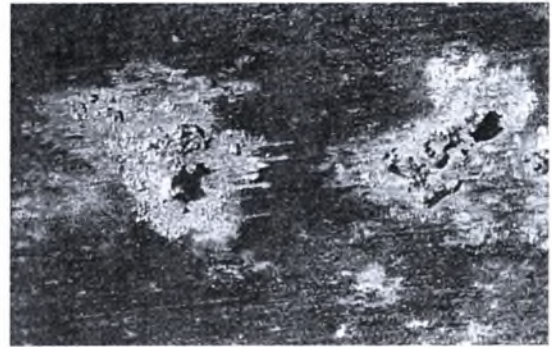
Εικόνα Θ-54: Στερεοσκοπία δοκιμίου Δ5 πειράματος Alternate Immersion Test AI 2024-T3. Μεγέθυνση \times 40 . Χρόνος έκθεσης 30 ημέρες. Exfoliation.
