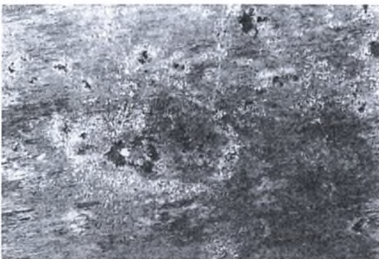
Εικόνα Θ-71: Στερεοσκοπία δοκιμίου Δ7 πειράματος Alternate Immersion Test AI 2024-T3. Μεγέθυνση \times 10 . Χρόνος έκθεσης 60 ημέρες.
