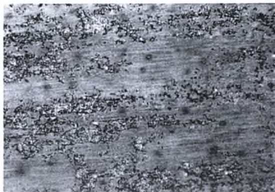
Εικόνα Η-71: Στερεοσκοπία δοκιμίου Μ9 πειράματος Modified EXCO Test. Μεγέθυνση \times 16 . Χρόνος έκθεσης 72 ώρες.
