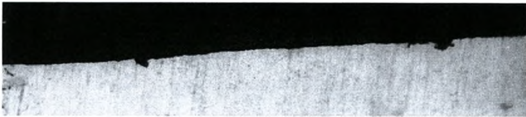
Εικόνα 5-7η: Μεταλλογραφία δοκιμίου NC4 πειράματος φυσικής διάβρωσης Al 2024-T3. Μεγέθυνση \times 50 . Χρόνος έκθεσης 12 μήνες.
