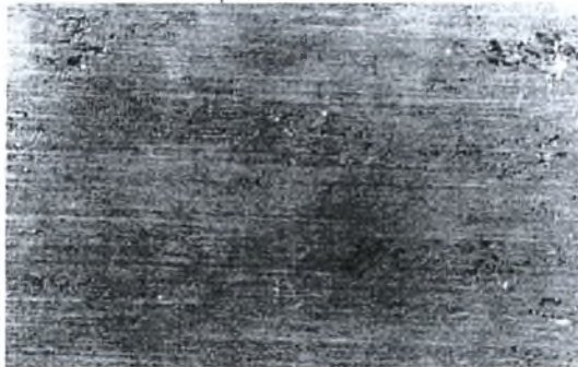
Εικόνα Z-35: Στερεοσκοπία δοκιμίου A24 πειράματος EXCO Test AI 2024-T3. Μεγέθυνση \times 10 . Χρόνος έκθεσης 24 ώρες.
