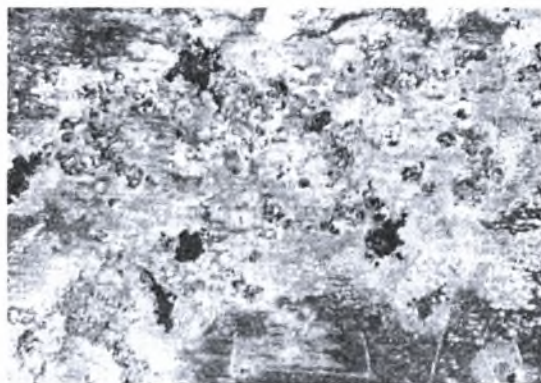
Εικόνα Θ-64: Στερεοσκοπία δοκιμίου Δ6 πειράματος Alternate Immersion Test AI 2024-T3. Μεγέθυνση \times 16 . Χρόνος έκθεσης 45 ημέρες.
