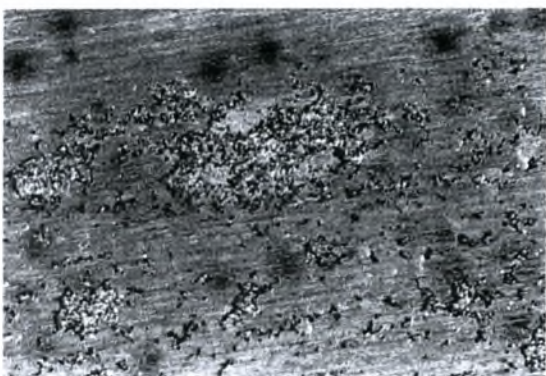
Εικόνα 5-26ια: Στερεοσκοπία δοκιμίου M7 πειράματος Modified EXCO Test. Μεγέθυνση \times 25 . Χρόνος έκθεσης 36 ώρες.
