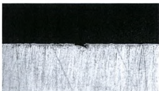
Εικόνα 5-27γ: Μεταλλογραφία δοκιμίου M2 πειράματος Modified EXCO Test. Μεγέθυνση \times 50 . Χρόνος έκθεσης 5 ώρες.
