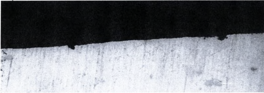
Εικόνα ΣΤ-81: Μεταλλογραφία δοκιμίου NC4 πειράματος φυσικής διαβρωσης Al 2024-T3. Μεγέθυνση \times 50 . Χρόνος έκθεσης 12 μήνες.
