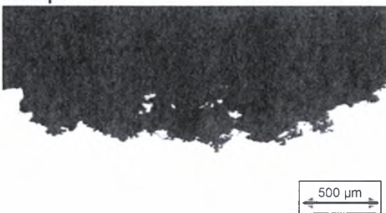
Εικόνα Θ-127: Μεταλλογραφία δοκιμίου Δ9 πειράματος Alternate Immersion Test AI 2024-T3. Μεγέθυνση \times 5 . Χρόνος έκθεσης 90 ημέρες.
