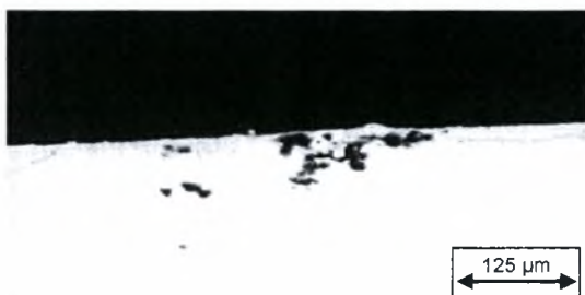
Εικόνα 5-27α: Μεταλλογραφία δοκιμίου M1 πειράματος Modified EXCO Test. Μεγέθυνση \times 20 . Χρόνος έκθεσης 2 ώρες.
