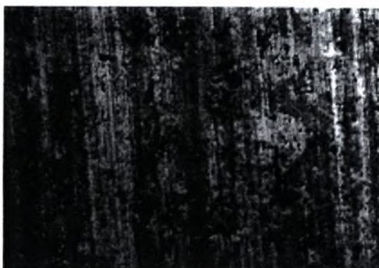
Εικόνα ΣΤ-10: Στερεοσκοπία δοκιμίου NC2 πειράματος φυσικής διάβρωσης ΑΙ 2024-Τ3. Μεγέθυνση \times 20 . Χρόνος έκθεσης 6 μήνες.
