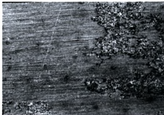
Εικόνα 5-26ιστ: Στερεοσκοπία δοκιμίου M9 πειράματος Modified EXCO Test. Μεγέθυνση \times 25 . Χρόνος έκθεσης 72 ώρες.
