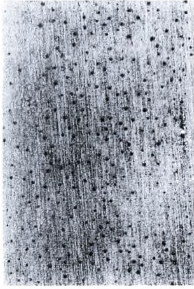
Εικόνα 6-3ζ: Στερεοσκοπία δοκιμίου M2 περιβάλλοντος Modified EXCO Test. Μεγέθυνση \times 10 . Χρόνος έκθεσης 5 ώρες.
