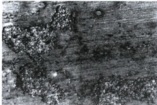
Εικόνα Η-39: Στερεοσκοπία δοκιμίου Μ6 πειράματος Modified EXCO Test. Μεγέθυνση \times 40 . Χρόνος έκθεσης 24 ώρες.
