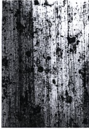
Εικόνα 6-3β: Στερεοσκοπία δοκιμίου NC6 πειράματος φυσικής διάβρωσης. Μεγέθυνση \times 20 . Χρόνος έκθεσης 18 μήνες.
