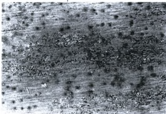
Εικόνα Η-44: Στερεοσκοπία δοκιμίου Μ7 πειράματος Modified EXCO Test. Μεγέθυνση \times 10 . Χρόνος έκθεσης 36 ώρες.
