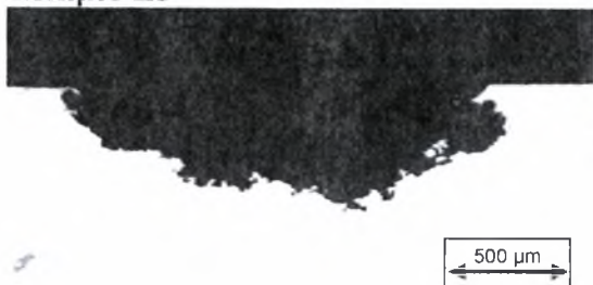
Εικόνα Θ-123: Μεταλλογραφία δοκιμίου Δ8 πειράματος Alternate Immersion Test AI 2024-T3. Μεγέθυνση \times 5 . Χρόνος έκθεσης 75 ημέρες.
