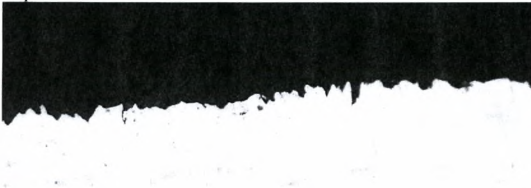
Εικόνα ΣΤ-95: Μεταλλογραφία δοκιμίου NC8 πειράματος φυσικής διαβρωσης Al 2024-T3. Μεγέθυνση \times 50 . Χρόνος έκθεσης 24 μήνες.
