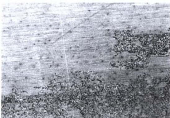
Εικόνα H-66: Στερεοσκοπία δοκιμίου M9 πειράματος Modified EXCO Test. Μεγέθυνση \times 10 . Χρόνος έκθεσης 72 ώρες.
