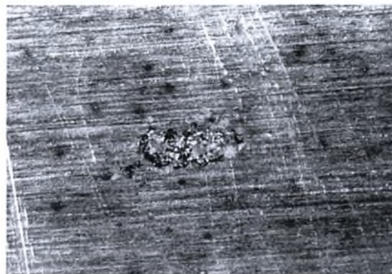
Εικόνα Η-69: Στερεοσκοπία δοκιμίου Μ9 πειράματος Modified EXCO Test. Μεγέθυνση \times 25 . Χρόνος έκθεσης 72 ώρες.
