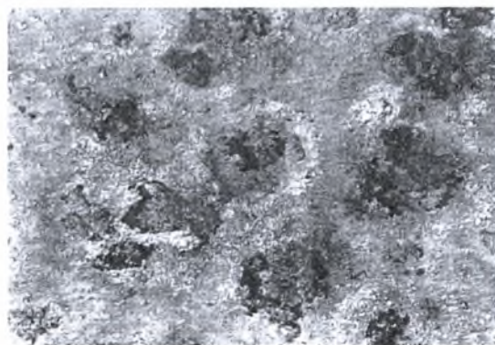
Εικόνα Θ-92: Στερεοσκοπία δοκιμίου Δ9 πειράματος Alternate Immersion Test AI 2024-T3. Μεγέθυνση \times 10 . Χρόνος έκθεσης 90 ημέρες.
