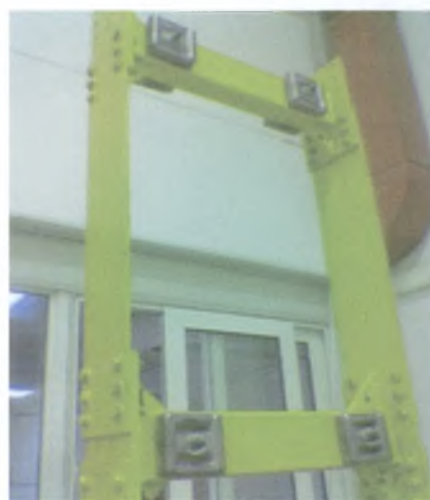
Εικόνα 4.2. Ενδεικτική στήριξη μαζών στην κατασκευή
