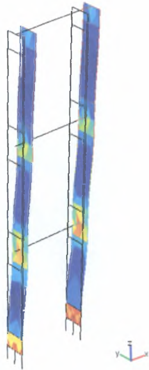
Σχήμα 5.6 Η 1 η καμπτική ιδιομορφή στον x άξονα στα 5,572 Hz
