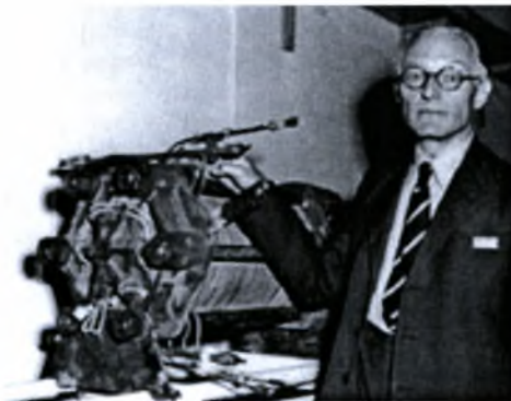
Σχήμα 2. 2 Το κελί καυσίμου ισχύος 5 kW του Francis Bacon
