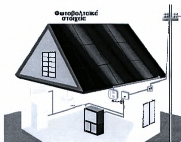
Σχήμα 1. 6 Χρήση φωτοβολταϊκών στοιχείων σε κατοικίες.
