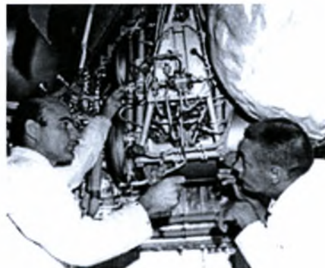
Σχήμα 2. 5 Το ΗΣΚ Gemini της NASA (πηγή www.generalhydrogen.com ).
