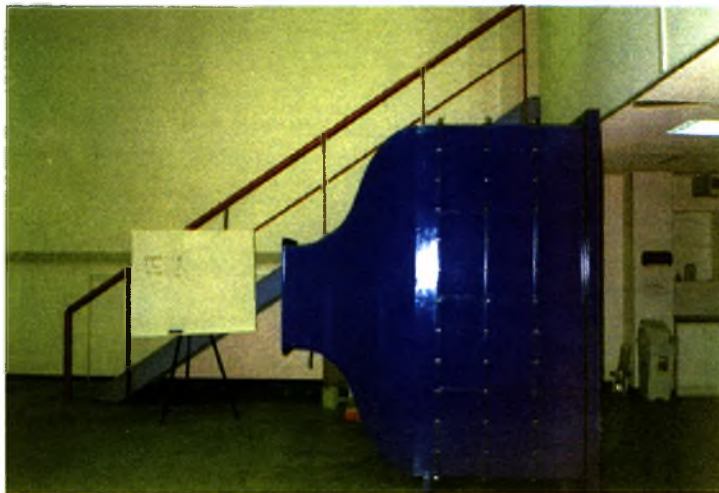
Σχήμα 5.1 Είσοδος της υποηχητικής αεροσήραγγας (πλάγια όψη)
