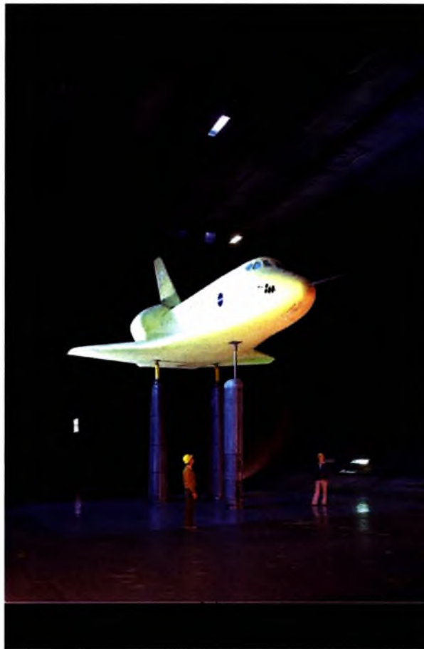
Σχήμα 3.12: Δοκιμές αεροδυναμικής σε διαστημικό λεωφορείο
