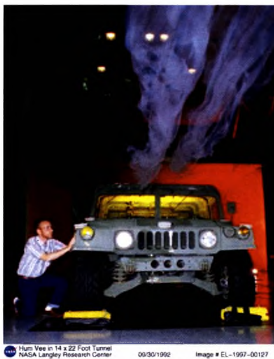
Σχήμα 3.11: Δοκιμές αεροδυναμικής σε αυτοκίνητο πραγματικών διαστάσεων
