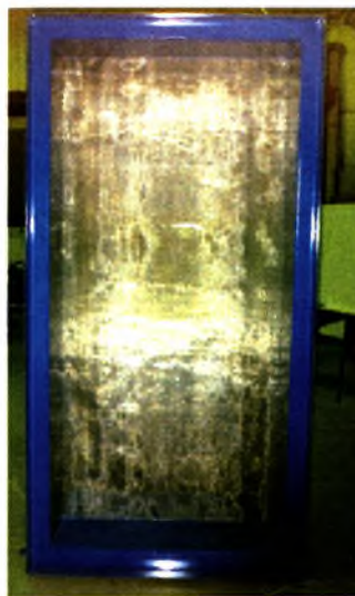
Σχήμα 5.7 Πλέγματα στην είσοδο της αεροσήραγγας
