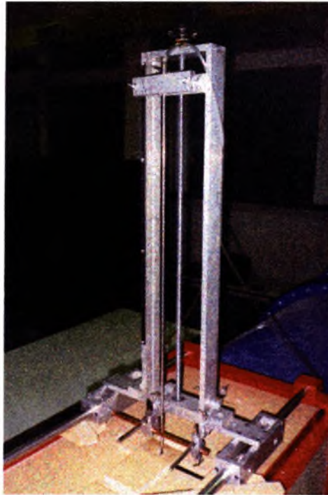
Σχήμα 5.19 Σύστημα μετακίνησης στην y -κατεύθυνση εγκατεστημένο στην αεροσήραγγα
