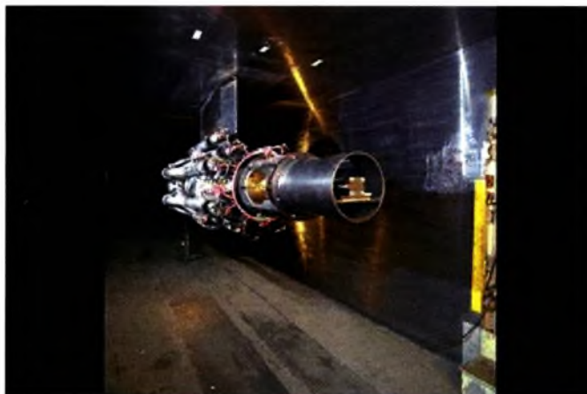
Σχήμα 3.10: Δοκιμές αεροδυναμικής σε στροβιλοκινητήρα αεροσκάφους
