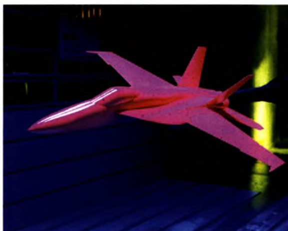
Σχήμα 3.8: Δοκιμές αεροδυναμικής σε μοντέλο μαγνητικού αεροσκάφους
