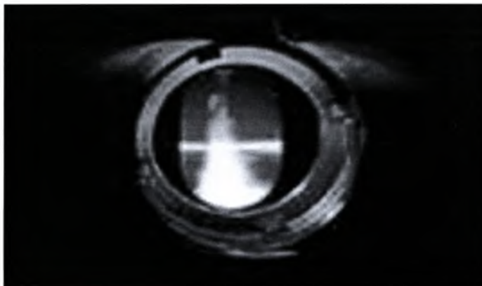
Σχήμα 4-12: Μέτρηση μέσα σε κινητήρα δοκιμής με LDA
