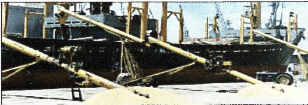
Εικόνα 9. Μέθοδος αναρρόφησης δημητριακών με κοχλίες
