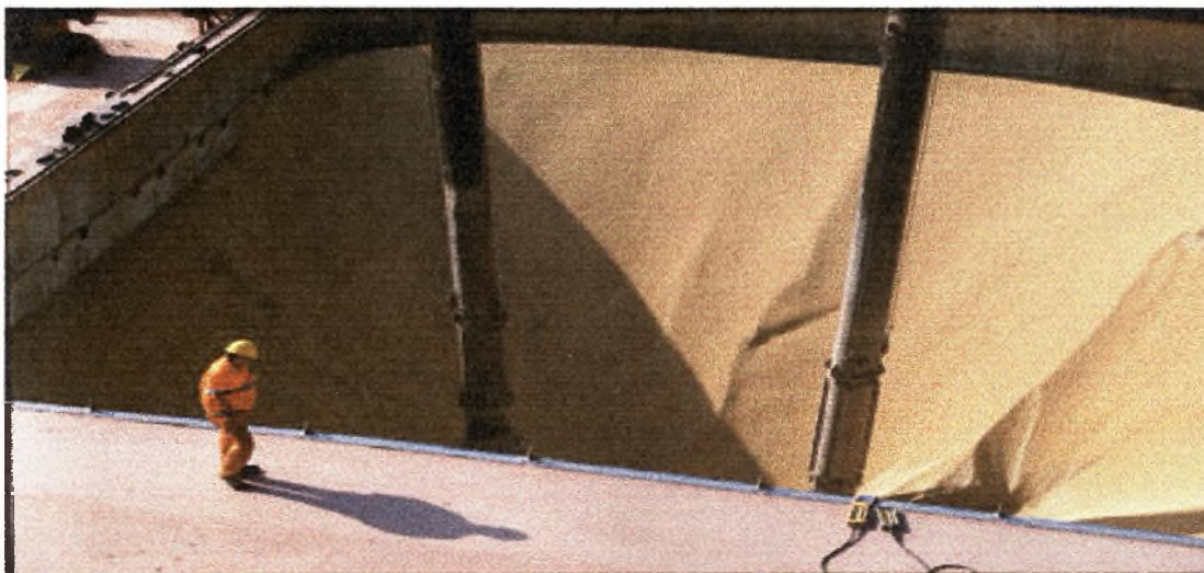
Εικόνα 4. Μέθοδος άντλησης δημητριακών από αμπάρι πλοίου
