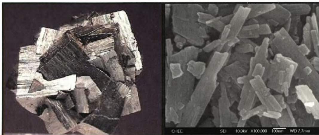
Σχήμα 4-1. α) Πρισματικοί κρύσταλλοι φυσικού γκαιτίτη και β) Εικόνα συνθετικών κρυστάλλων γκαιτίτη από ηλεκτρονικό μικροσκόπιο διερχόμενης δέσμης (TEM) ( \times 100000 )
