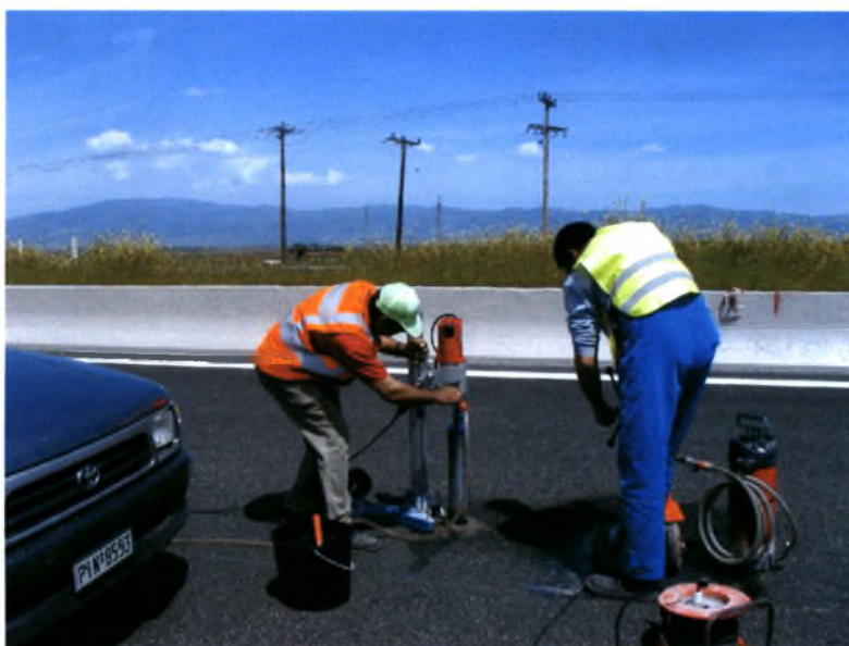
Φωτογραφία 26: Κοπή πυρήνων ασφαλτοτάπητα για ποιοτικό έλεγχο
