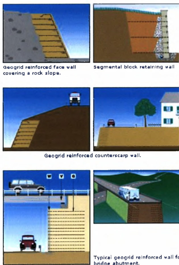
Σχήμα 3.1 Ενδεικτική απεικόνιση εφαρμογών ενίσχυσης εδάφους με γεωπλέγματα, Rimoldi P. (1991)
