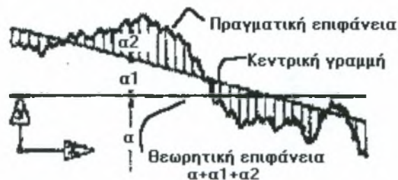
Σχ.1.5: Απόκλιση θεωρητικής και πραγματικής επιφάνειας.
