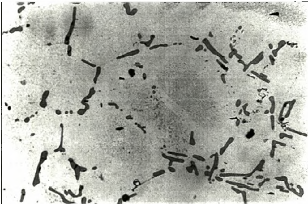
Φώτο. 5.5.2 : Κράμα A357 + 1.0 Cu + 0.7 Ag, μεγέθυνση x200.
