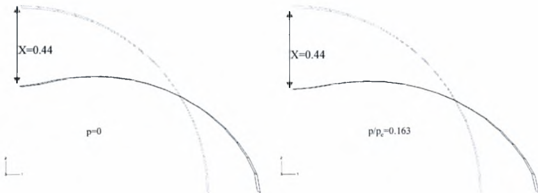
Σχήμα 2-12. Σύγκριση των παραμορφωμένων πλεγμάτων για μηδενική πίεση και p=100 \text{ psi} : στοιχεία S4R.
