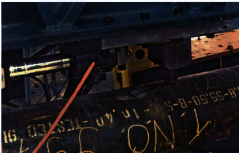
Σχήμα 1-3. Πειραματική διάταξη της T.N.O. για την προσομοίωση κατάρρευσης σωλήνα υπό την επίδραση διεισδυτή μορφής λεπίδας.
