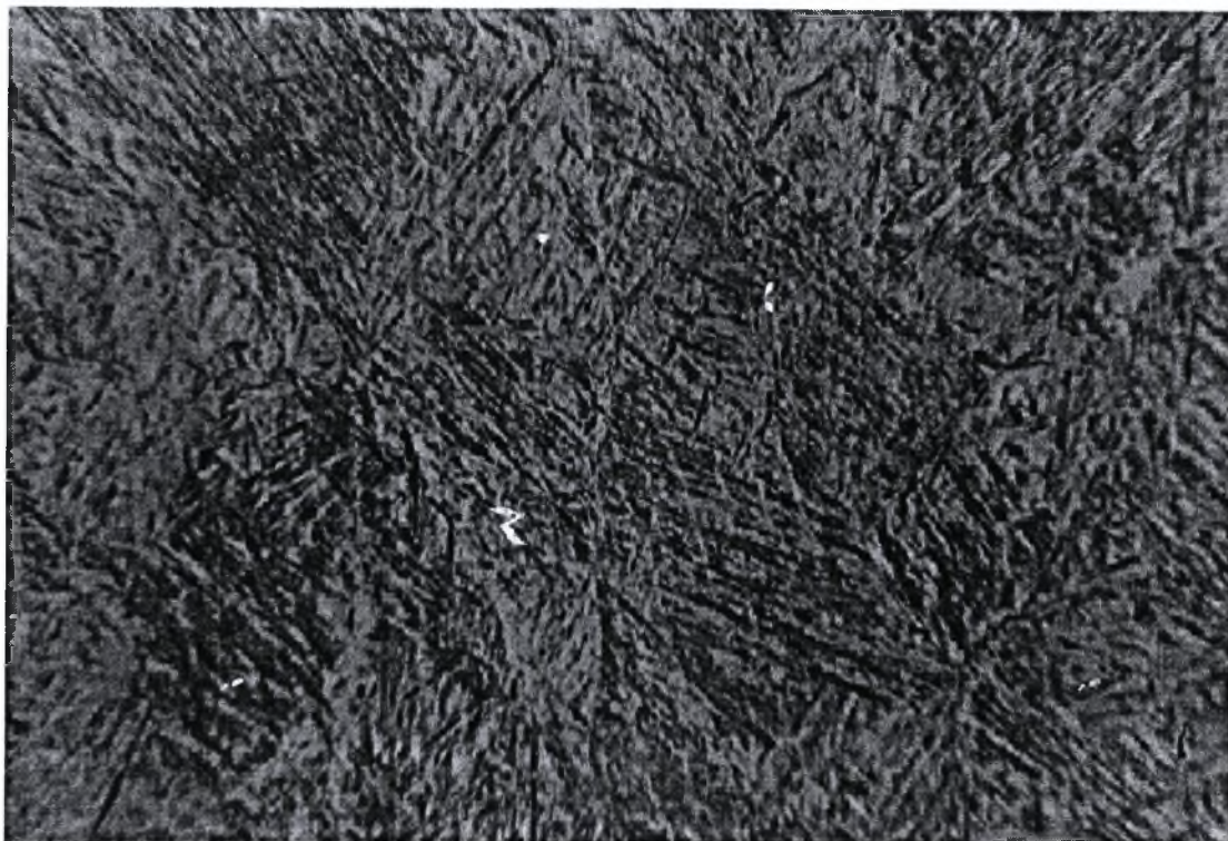
Εικόνα 6. (x500). Μαρτενσίτης στη λίμνη συγκόλλησης, δοκίμιο 1: 320mm/min, f.p +1mm, He 2 bar
