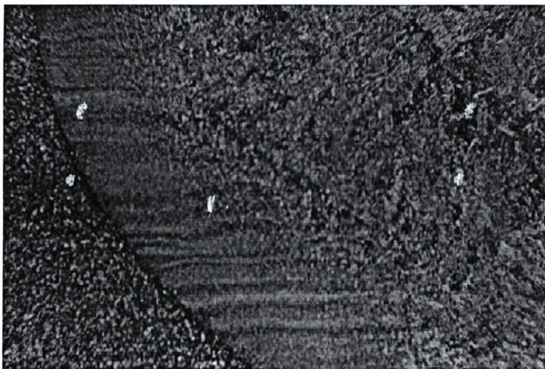
Εικόνα 13. (x200). Φαινόμενο banding στη θερμικά επηρεαζόμενη ζώνη, δοκίμιο 1: 320mm/min, f.p +1mm, He 2 bar
