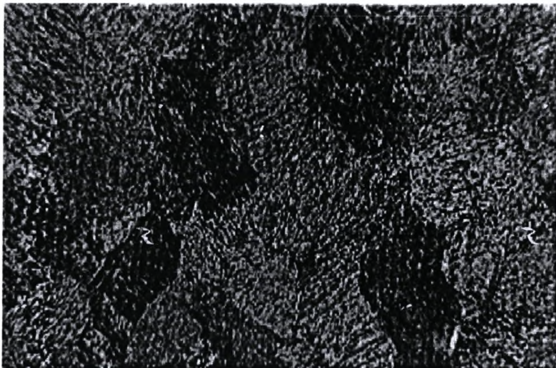
Εικόνα 8. (x200). Κυψέλες στη λίμνη συγκόλλησης, δοκίμιο 16: 200mm/min, f.p +3mm, He 0,5 bar
