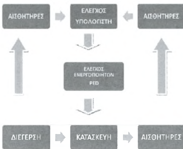
Σχήμα 1.4. Κατασκευή με ημι-ενεργητικό έλεγχο
