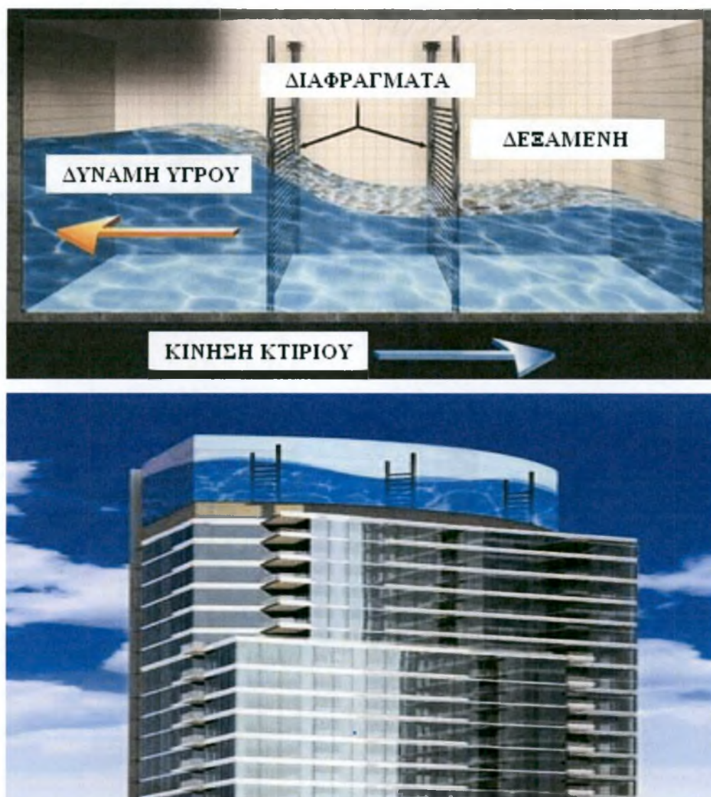
Σχήμα 2.38. Απεικόνιση ενός συντονισμένου αποσβεστήρα υγρού (TLD)
