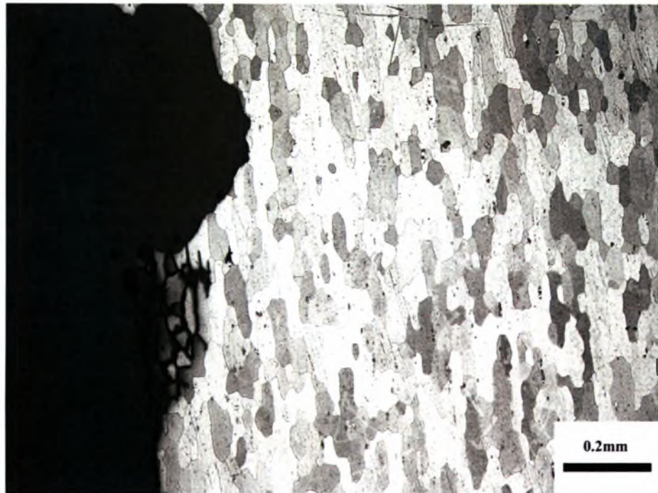
Σχήμα 4.27: Περικρυσταλλική διάβρωση στο δοκίμιο 2 ( \sigma_{\max} = 65 , N_f = 10.248.000 ).
