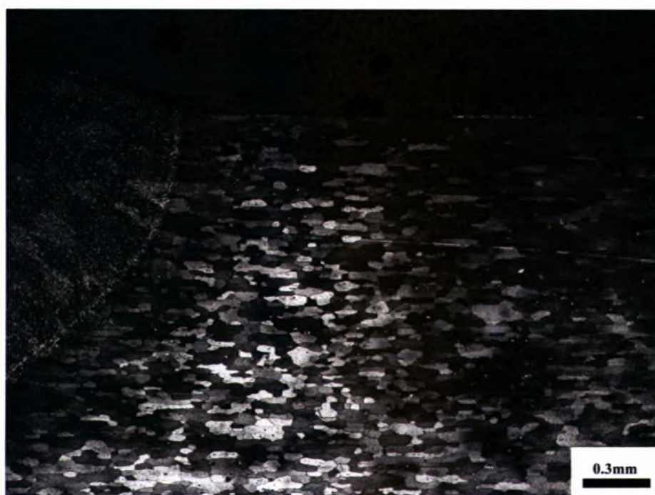
Σχήμα 4.75: Αδιάβρωτη επιφάνεια κοντά στο πρόσωπο της συγκόλλησης στο δοκίμιο 9a ( \sigma_{\max} = 75 , N_f = 182.304 ).
