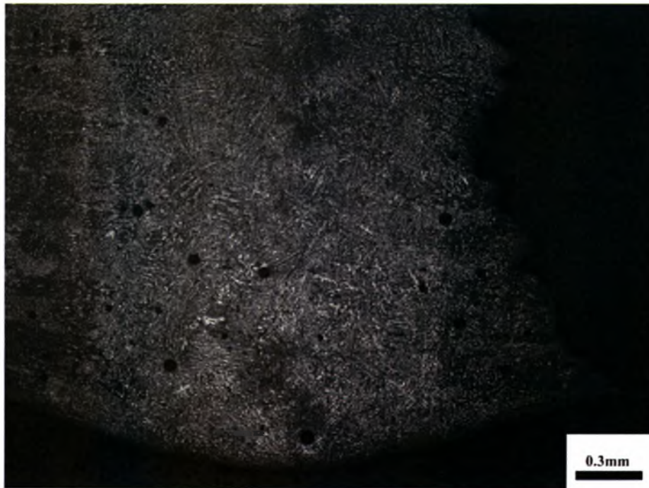
Σχήμα 4.57: Πόροι στο κέντρο της συγκόλλησης στο δοκίμιο 15b ( \sigma_{\max} = 150 , N_f = 1.020.939,50 ).
