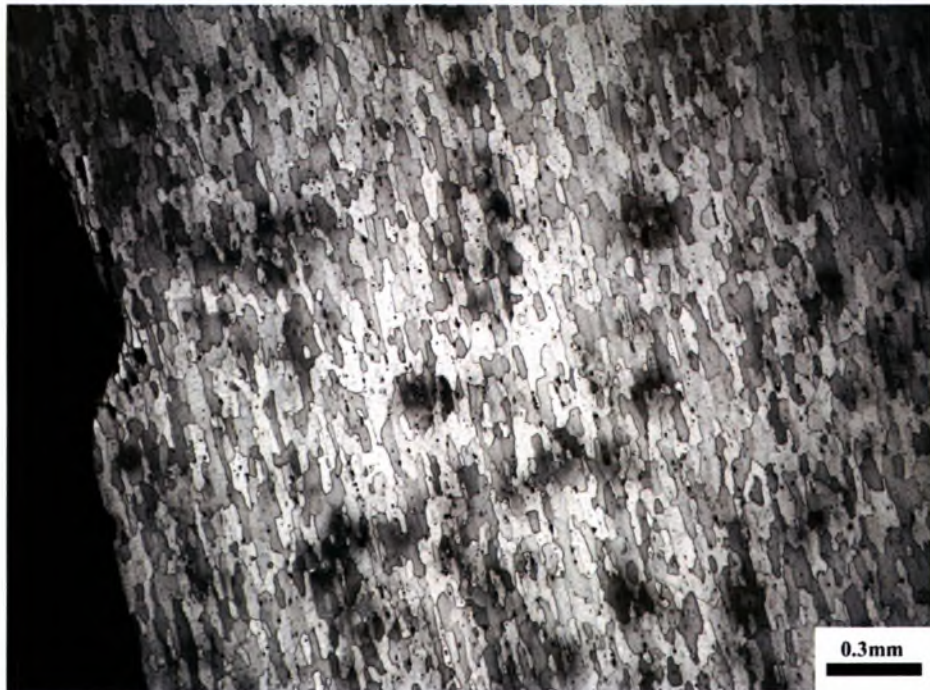
Σχήμα 4.33: Το φαινόμενο της διάβρωσης δεν συνεχίζεται μακριά από τη συγκόλληση στο δοκίμιο 3b ( \sigma_{\max} = 75 , N_f = 857.628 ).
