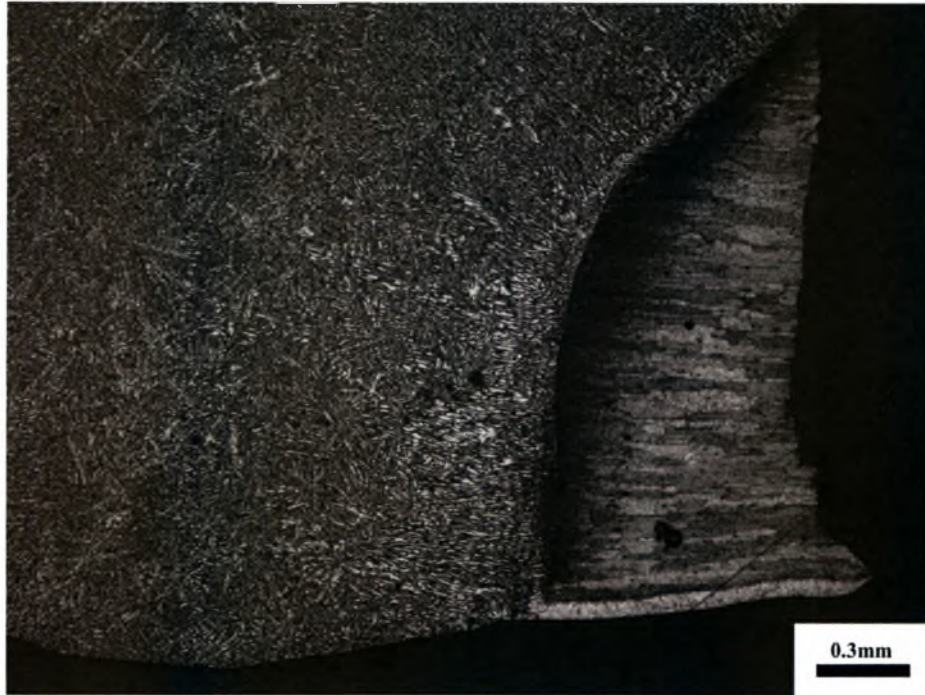
Σχήμα 4.111: Εκκίνηση ρωγμής κόπωσης στη ρίζα της συγκόλλησης και διάδοσή της στο μέταλλο συγκόλλησης στο δοκίμιο 20a ( \sigma_{max} = 150 , N_f = 162.232 ).
