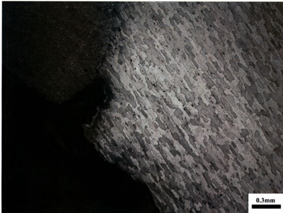
Σχήμα 4.34: Πιθανή έναρξη ρωγμής κόπωσης λόγω ύπαρξης εγκοπής στο δοκίμιο 3a ( \sigma_{\max} = 75 , N_f = 857.628 ).
