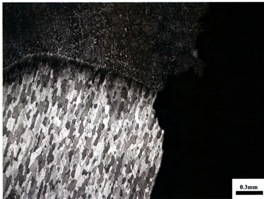
Σχήμα 4.26: Εμφάνιση έντονης διάβρωσης στη ρίζα του δοκιμίου 2 ( \sigma_{\max} = 65 , N_f = 10.248.000 ).
