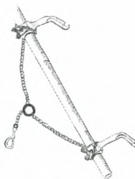
Εικόνα 6-14 Το αντίβαρο χρησιμοποιείται για να αντισταθμίσει την ροπή στροφής της Διάταξης γύρω από τις προσωρινές ράβδους.
