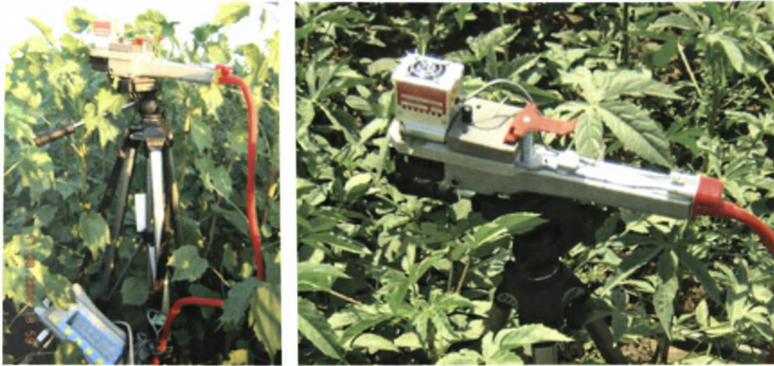
Εικόνα 2.2: Το μηχάνημα φωτοσύνθεσης (LC-pro) κατά τη διάρκεια μετρήσεων σε φύλλα κενάφ, ποικιλία Everglades 41 (αριστερά) και ποικιλία Tainnung 2 (δεξιά) στον Παλαμά Καρδίτσας, το 2004.
