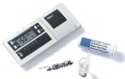
Εικόνα 12. Συσκευή προσδιορισμού της βιταμίνης C
