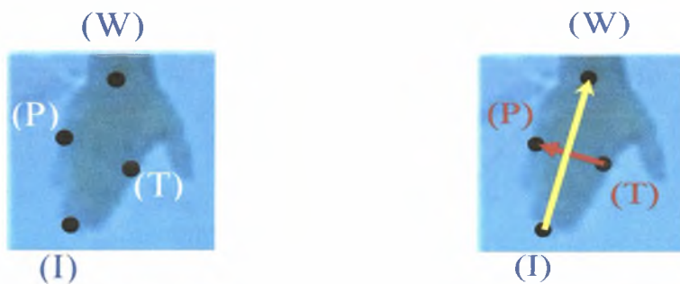
Σχήμα 15 και 16: Ορισμός του επιπέδου του χεριού από 4 σημεία, και τα 2 διανύσματα που ορίζονται σ' αυτό.
