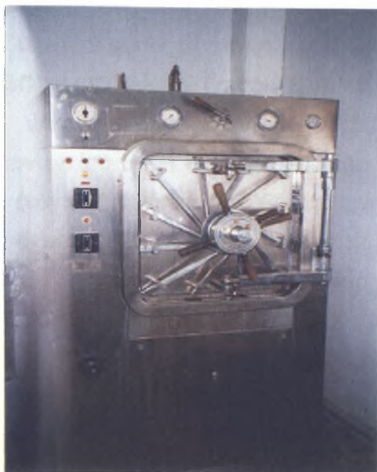
Εικόνα 4.2. Ο κλίβανος υγρής αποστείρωσης.
