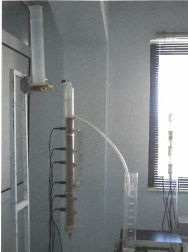
Σχήμα 3.8 Πειραματική διάταξη για τη μελέτη της αθροιστικής διήθησης
