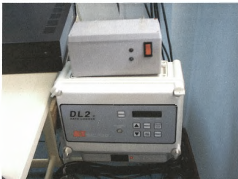
Εικόνα 2.4 Καταχωρητής δεδομένων (Data Logger)
