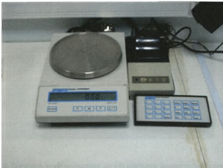
Εικόνα 2.6 Ψηφιακός ζυγός Adam Equipment, ακρίβειας 2 δεκαδικών ψηφίων
