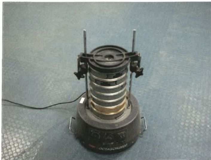
Εικόνα 2.8 Συσκευή κοσκινίσματος με έξι κόσκινα διαφορετικών οπών
