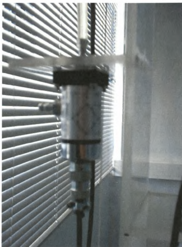
Εικόνα 2.3 Μετατροπέας πίεσης (pressure transducer)
