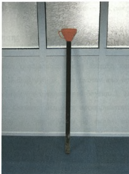
Σχήμα 3.6 Πλαστική σωλήνα για την πλήρωση της στήλης
