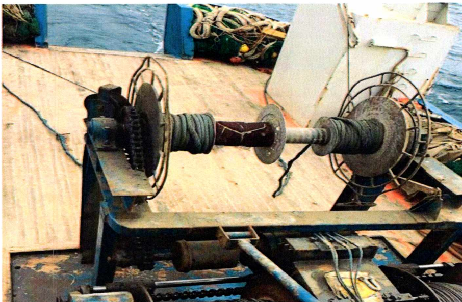
Εικόνα 04: Βίντσι, η κατασκευή για την ανύψωση της τράτας και των συρματοπλεγμάτων.
