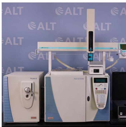
Εικόνα1.1 Σύστημα αέριου χρωματογράφου-φασματογράφου μάζας όμοιο με αυτό που χρησιμοποιήθηκε στην παρούσα εργασία [89]
