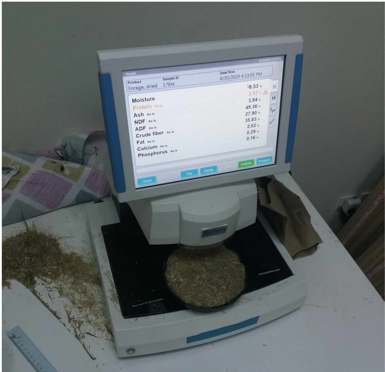
Φωτογραφία 7: Συσκευή NIR στο εργαστήριο Γεωργίας και Εφαρμοσμένης Φυσιολογίας Φυτών
