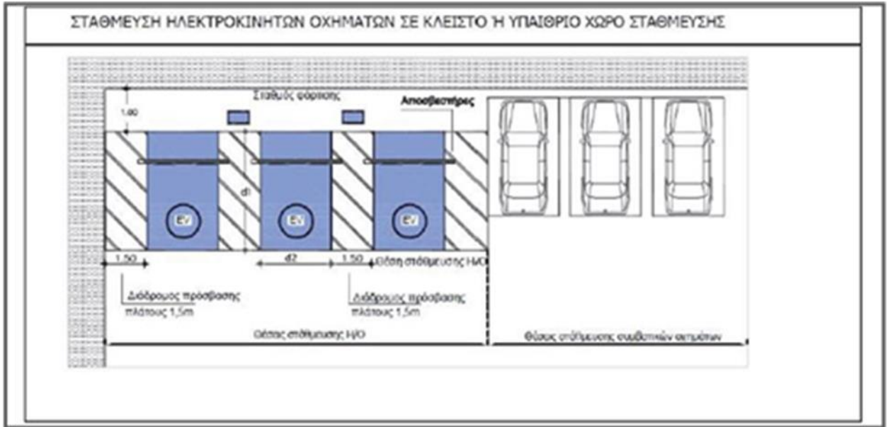
Σχήμα 3.2: Ενδεικτική χωροθέτηση θέσεων στάθμευσης και σταθμών επαναφόρτισης σε κλειστό ή υπαίθριο χώρο στάθμευσης (Πηγή: ΦΕΚ Β'2010/04.06.2019).
