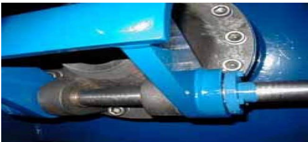
Εικόνα 304: Ο εκτροπέας δέσμης ενός ακροφυσίου. Ανάκτηση από: Canyon Hydro, An Introduction to Hydropower Projects and Planning , 2013.
