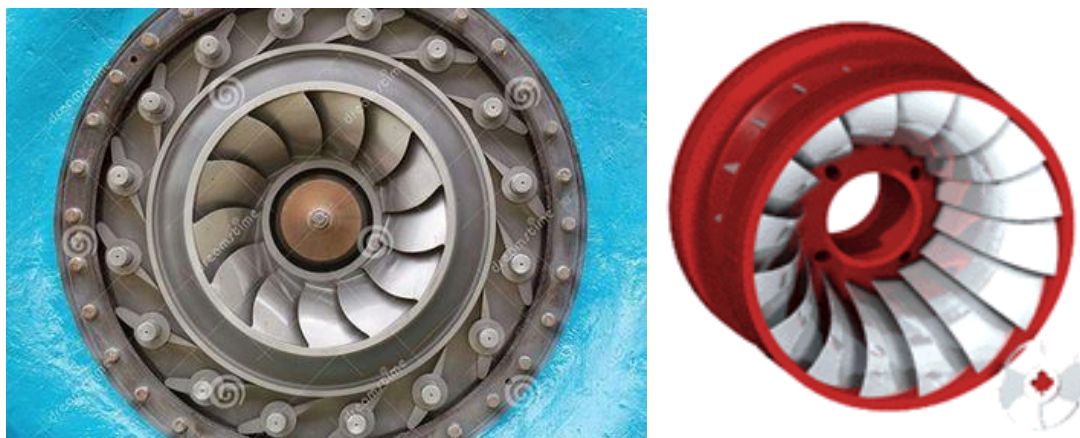
Εικόνα 12: Στροφείο του Francis. Ανάκτηση από: dreamstime.com και Σκόδρας Γ., Ήπιες και νέες μορφές ενέργειας, Τμήμα Μηχανολόγων Μηχανικών, Πανεπιστήμιο Δυτικής Μακεδονίας, Κοζάνη 2015.
