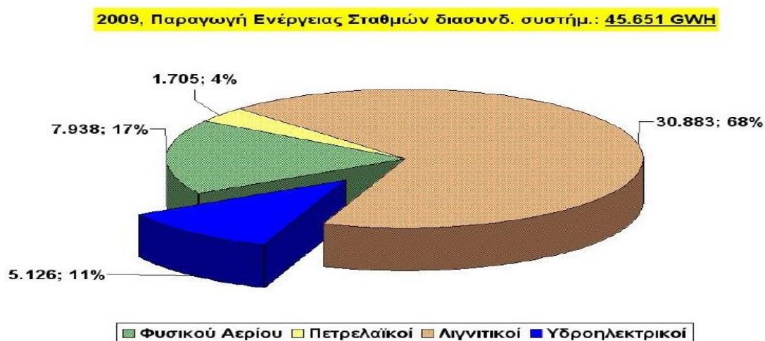
Εικόνα 2: Παραγωγή ενέργειας (σε GWH) σε εργοστάσια ηλεκτροπαραγωγής με χρήση διαφορετικών μορφών ενέργειας. Ανάκτηση από: Αργυράκης Ι., Η υδροηλεκτρική παραγωγή της ΔΕΗ Α.Ε, ΤΕΕ, 2009.
