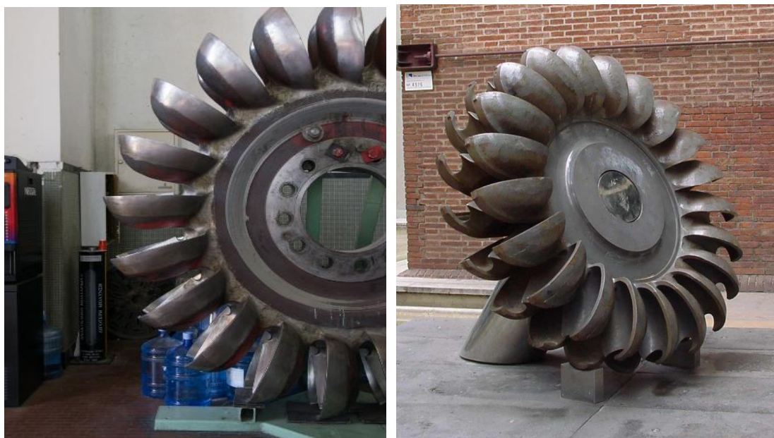
Εικόνα 8: Πρόσωση και πλάγια όψη στροβίλου Pelton. Διακρίνεται η ιδιαίτερη γεωμετρία των σκαφιδίων. Ανάκτηση από: https://geo.civ.uth.gr/index.php/el/events-gr/30-ekpaideytikes-ekdromes και https://energyeducation.ca/encyclopedia/Pelton_turbine .
