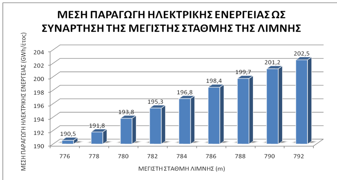
Εικόνα 301: Διάγραμμα μέσης παραγωγής ηλεκτρικής ενέργειας ως συνάρτηση της μέγιστης στάθμης της λίμνης. Ανάκτηση από: Αρχείο ΥΗΣ Πλαστήρα (κατόπιν επεξεργασίας).
