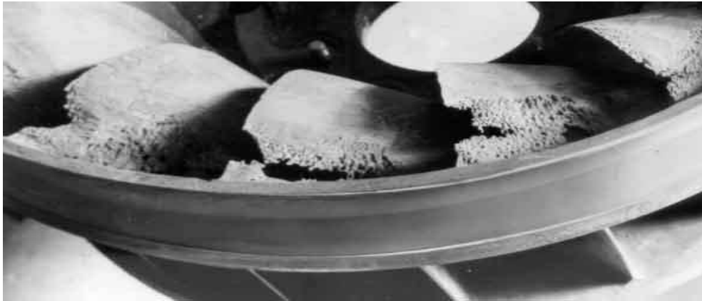
Εικόνα 305: Το αποτέλεσμα του φαινομένου της σπηλαιώσης. Ανάκτηση από: https://www.researchgate.net/figure/Cavitation-damage-on-the-blades-at-the-discharge-from-a-Francis-turbine_fig94_36721047
