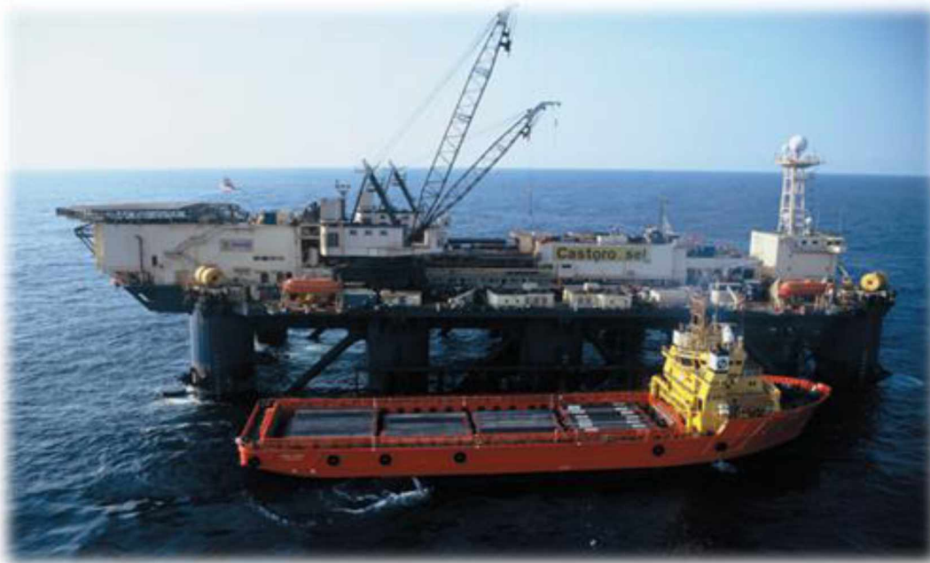
Σχήμα1. 4 Η φορηγίδα Castoro Sei εγκατάστασης αγωγού με S-Lay (Κυριακίδες_Corona 2007)
