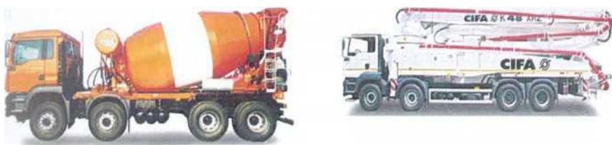
Εικόνα 6.3 Μηχανήματα (α) μεταφοράς και (β) άντλησης σκυροδέματος (Πολύζος, Σ., 2018)
