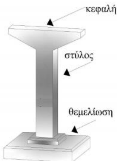
Σχήμα 4.5 Δομικά στοιχεία ακρόβαθρου (Πηγή: ΕΡΓΟΣΕ Α.Ε.)
