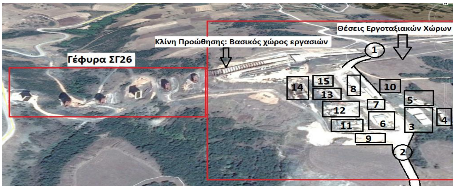
Σχήμα 9.1 Ρεαλιστική κάτοψη του εργοταξίου και προτεινόμενες θέσεις εργοταξιακών χώρων
