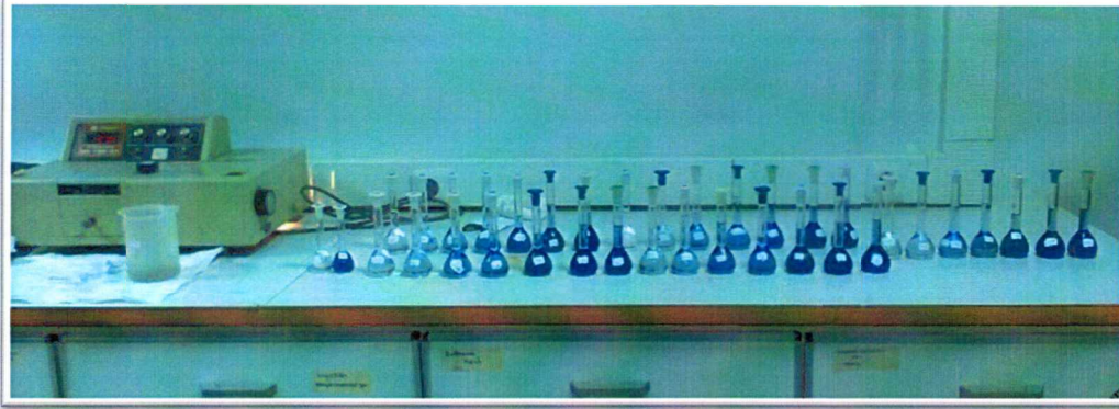
Εικόνα 3: Δείγματα με ανάπτυξη χρώματος για μέτρηση φωσφόρου.
