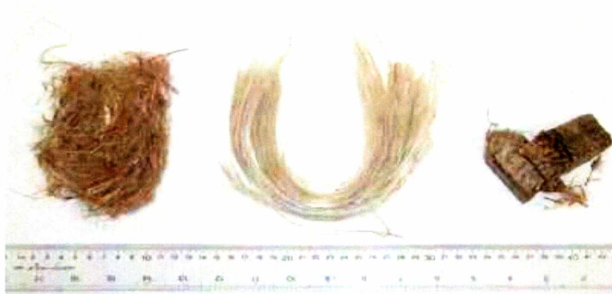
Εικόνα 1.8 Ινώδη νήματα φλοιού κενάφ. Νήματα μετά την κοπή με μηχανήμα (αριστερά), ινώδη νήματα μετά τη διαδικασία αφύγρανσης (κέντρο) και ινώδη νήματα συμπιεσμένα σε κύβο.
